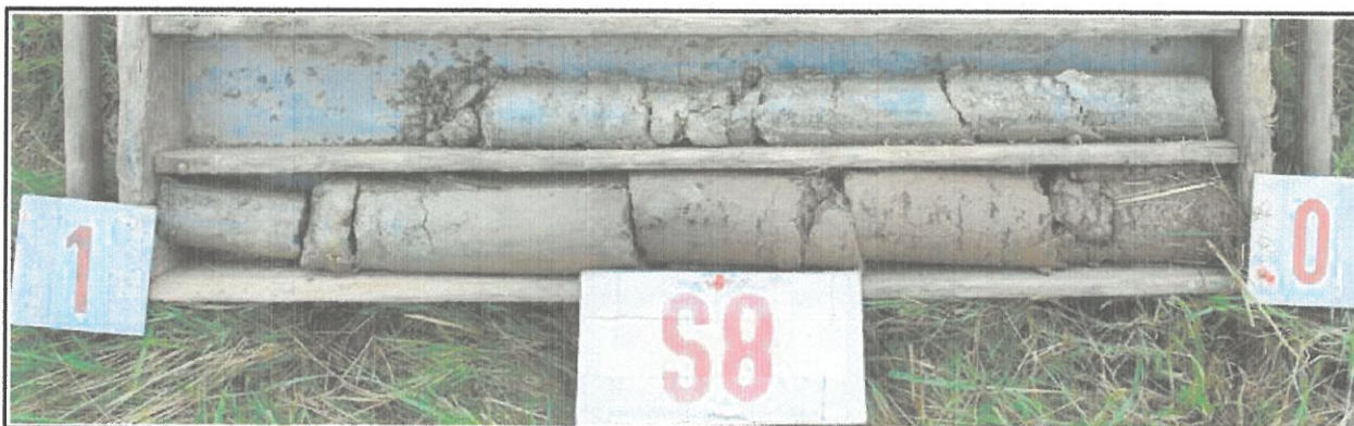
Obr.č. 16 : Pohled na geologický profil sondy S8, hluboké 1,7 m. Svrchní vrstva hlíny písčité, drnové, nasedá v hloubce 0,2 m na jílu hlinitý, tuhý. V hloubce 0,7 m dokumentováno stříbrošedé eluvium pararuly, třídy R6, slídnato-písčité, v ruce roztíratelné (mastný otěr). Podzemní voda se v sondě neprojevila.
