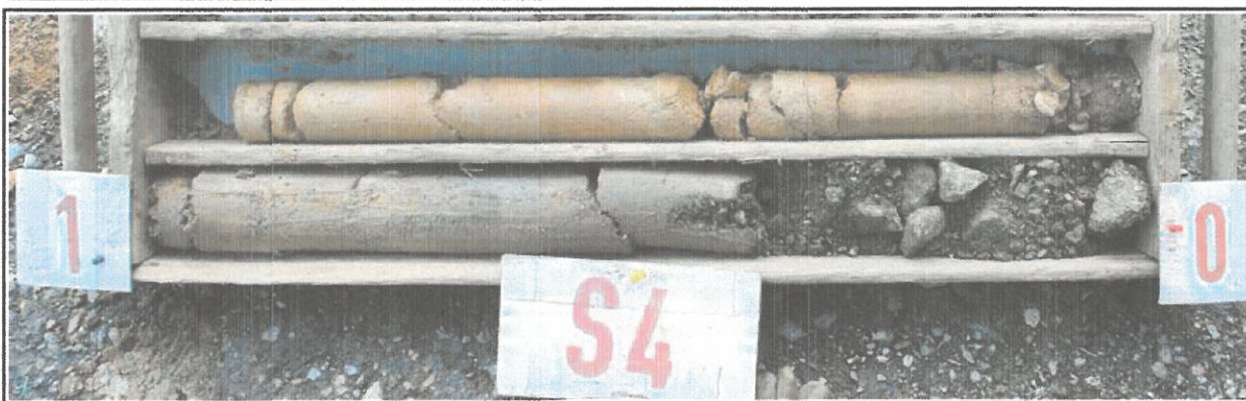
Obr.č. 8 : Pohled na geologický profil sondy S4, hluboké 1,9 m. Nová konstrukce cesty je 250 mm mocná , tvořená vrstvou recyklátu se zástříkem , s podsypem 0-32, navrstvená na původní povrch cesty zpevněný úlomky krytiny a kameniva. V hloubce 0,4 m zastižena jíl písčítý, pevný, s křemennou drtí do 5 mm . V hloubce 0,9 m dokumentováno eluvium pevnostní třídy R6, zrnitostní povahy zjílovatělé zeminy, pevné konzistence. Přítomnost podzemní vody se v sondě neprojevila.
