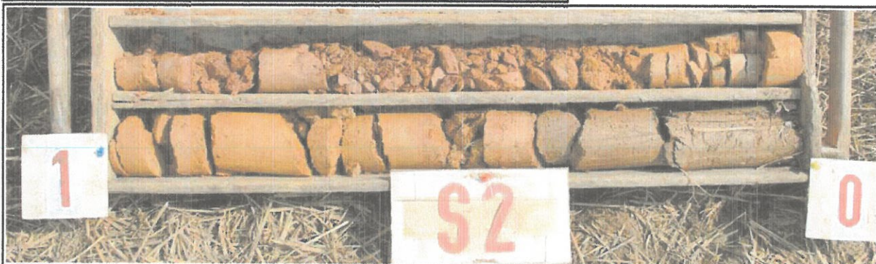
Obr.č. 4 : Pohled na geologický profil sondy S2, hluboké 2,0 m. Pod vrstvou ornice 0,25 m mocnou zastižena hlína jílovito-písčitá , pevná. V hloubce 0,5 m dokumentováno horninové eluvium třídy R6 , zrnitostní povahy zjílovatělé zeminy, pevné, v ruce roztíratelné, od 1,5 m s přechodem do zcela zvětralé pararuly, ulehlé, třídy R6-R5 , v ruce drolitelné. Podzemní voda se v sondě neprojevovala.
