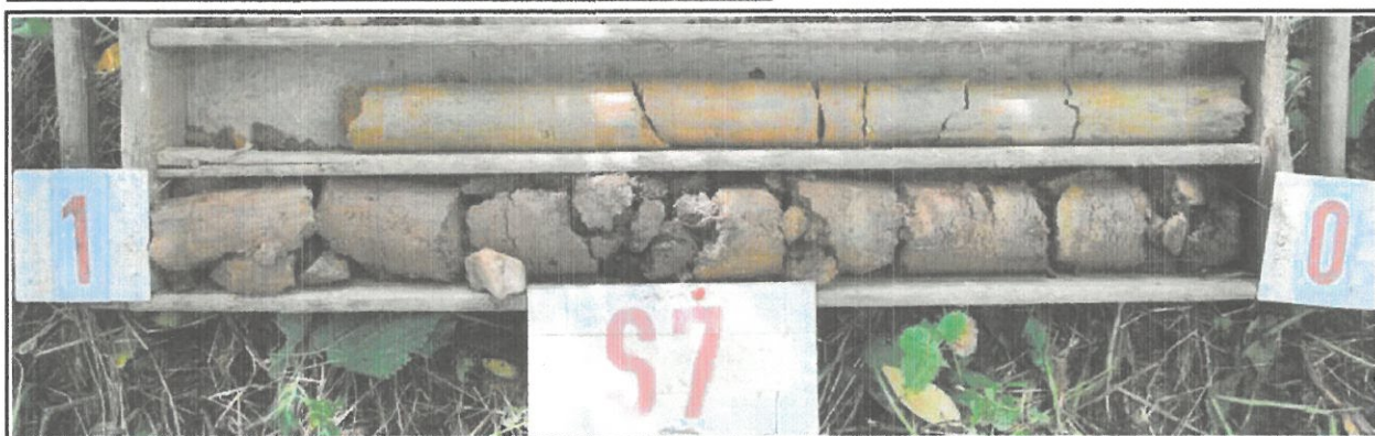
Obr.č. 14 : Pohled na geologický profil sondy S7, hluboké 1,9 m. Pod vrstvou jílovito-písčité navážky 0,5 m mocné zastižena hlína písčité, pevná, nasedající v hloubce 1,0 m na jílu písčité, pevný, s příměsí křemen-živcové drtě do 1 cm. Podzemní voda nebyla v sondě zastižena.
