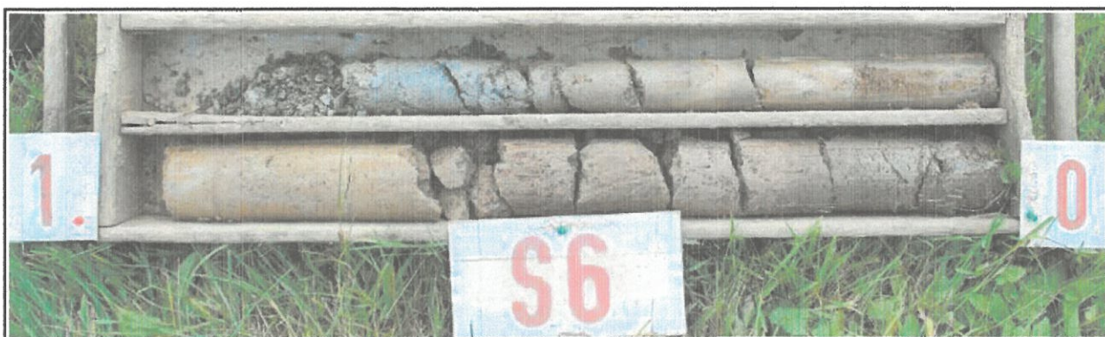
Obr.č. 12 : Pohled na geologický profil sondy S6, hluboké 1,9 m. Svrchní část profilu vyplňuje písčité hlína, pevná , svrchu humózní, nasedající v hloubce 0,6 m na jílu hlinito-písčité, pevný, s příměsí živcové drtě. V hloubce 1,5 m dokumentováno stříbrošedé eluvium pararuly, třídy R6, slídnato-písčité. Podzemní voda nebyla v sondě zastižena.
