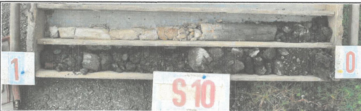
Obr.č. 20 : Pohled na geologický profil sondy S10, hluboké 2,0 m. Konstrukce cesty je 500 mm mocná, tvořená vrstvou obalovaného kameniva založeném do živičného recyklátu a štěrkodrtě 0-32. Těleso cesty je založeno do hlinito-kamenitého násypu, výšky 0,7 m . V hloubce 1,2 m dokumentován písčitý jíl, pevný s prolohou rezavě-žlutého písku. Podzemní voda ustálena 1,65 m pod niveletou cesty.
