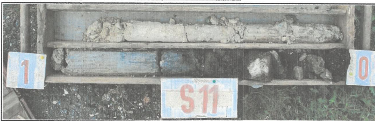
Obr.č. 22 : Pohled na geologický profil sondy S11, hluboké 1,9 m. Konstrukce cesty je 300 mm mocná, tvořená vrstvou obalovaného kameniva a podsypem se směsí živičného recyklátu a makadamu 32-63. Založená je do stabilizující vrstvy kameny 63-125 s výplní živičného recyklátu mocnosti 250 mm . V hloubce 0,55 m dokumentován modrošedý jíl písčitý, pevný, přecházející v hloubce 0,9 m do bělošedého kaolinického písku, pevné konzistence. Hladina podzemní voda ustálena 1,35 m pod niveletou cesty.
