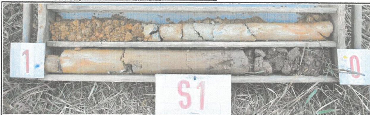
Obr.č. 2 : Pohled do vzorkovnice na geologický profil sondy S1, hluboké 2,0 m. Pod vrstvou ornice 0,3 m mocnou zastižen jíl písčito-hlinitý, pevný, od 0,7 m jíl písčitý, pevný, s rozptýlenou křemen-živcovou drť do 5 mm. V hloubce 1,2 m dokumentováno eluvium pevnostní třídy R6, zrnitostní povahy zjílovatělé zeminy, pevné. Hloubení ukončeno ve zcela zvětralé žule, velmi málo pevné, charakteru jílovitého písku, hrubé zrnitosti. Podzemní voda nebyla v sondě zastižena.
