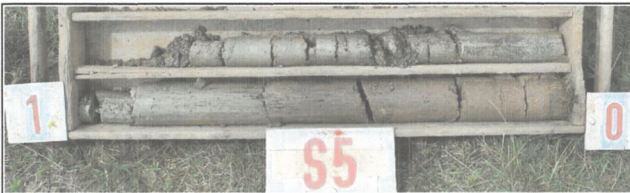
Obr.č. 10 : Pohled na geologický profil sondy S5, hluboké 1,8 m. Svvrchní část profilu vyplňuje písčítá hlína, pevná , nasedající v hloubce 0,3 m na jíl hlinito-písčítý, pevný, s příměsí živcové drtě. V hloubce 1,0 m dokumentováno stříbrošedé eluvium pararuly, třídy R6, slídnato-písčité. Podzemní voda nezastižena.
