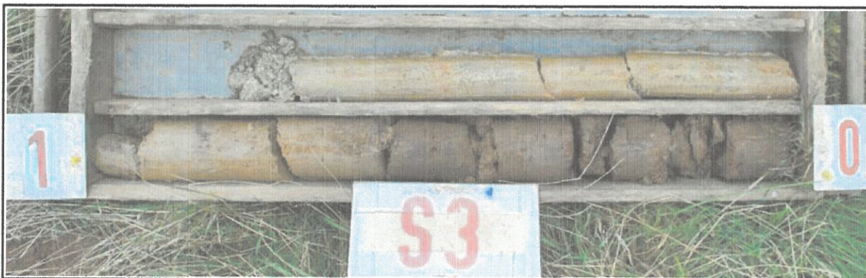
Obr.č. 6 : Pohled na geologický profil sondy S3, hluboké 1,8 m. Pod vrstvou písčité hlíny 0,2 m mocné zastižen hnědý jílovitý písek, soudržný, velmi pevný , nasedající v hloubce 0,6 m na jíl písčitý, pevný, s rozptýlenou křemen-živcovou drť . V hloubce 0,9 m dokumentováno eluvium pevnostní třídy R6, zrnitostní povahy zjílovatělé zeminy, pevné, v ruce roztíratelné. Hloubení ukončeno ve zcela zvětralé žule, charakteru jílovito-písčité zeminy, hrubé , s vyrostlicemi živců do vel. 5 mm. Podzemní voda se v sondě neprojevila.
