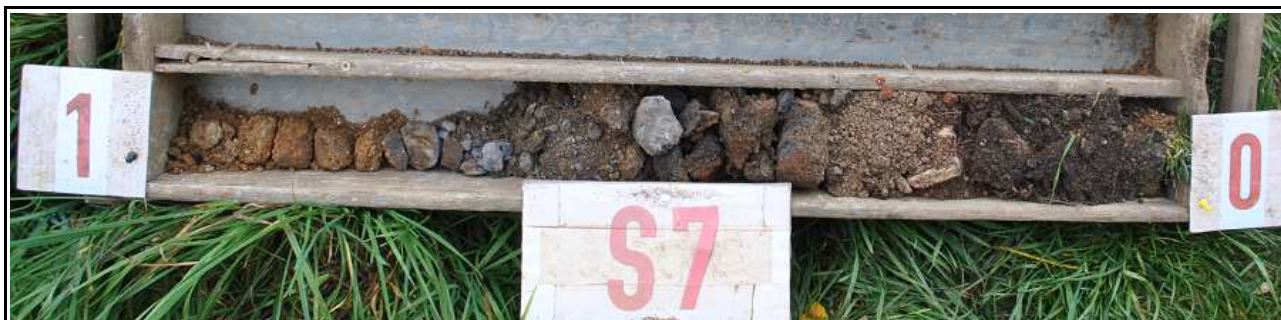
Obr.č. 14 : Pohled na geologický profil sondy S7, hluboké 1,0 m. Pod svrchní zazemněnou drnovou vrstvou tl. 0,2 m zastiženo násypové těleso cesty výšky 600 mm. Vrstvené je z nesourodého materiálu obsahující stavební odpad a hrubé kameny přes 200 mm . Hloubení ukončeno v rezavém hlinitém písku, velmi ulehém, s úlomky žuly do vel. 2 cm. Podzemní voda se v sondě neprojevila.
