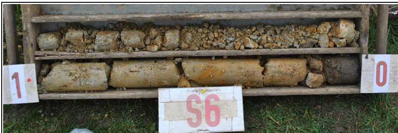
Obr.č. 12 : Pohled na geologický profil sondy S4, hluboké 2,0 m. Pod zazemněnou drnovou vrstvou zastižen žlutorezavý-světle mramorovaný jíl písčítý, pevný , s rozptýlenou drtí do 5 mm, ojed. úlomek vel. 3 cm . V hloubce 0,6 m nasedá na eluvium žuly, pevnostní třídy R6 , s ukončením hloubení ve zcela zvětralých žulových partiích, velmi ulehých, třídy R6-R5. Podzemní voda se v sondě neprojevila.
