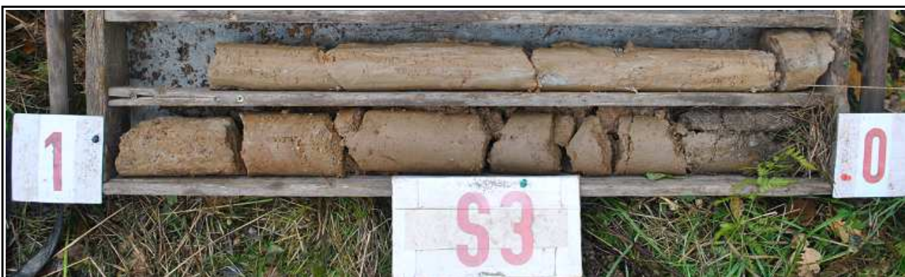
Obr.č. 6 : Pohled na geologický profil sondy S3, hluboké 1,9 m. Svvrchní písčité hlína drnová tl. 150 mm nasedá na světle hnědý písek hlinitý, soudržný-drolitelný s příměsí ostrohr. úlomků. V hloubce 0,8 m zastižena žlutorezavý- světle šedě mramorovaný jíl písčitý, tuhý až pevný, s rozptýleným štěrčkem do 5 mm, méně polozaobl. úl. vel. 1 cm. Podzemní voda se v sondě neprojevovala.
