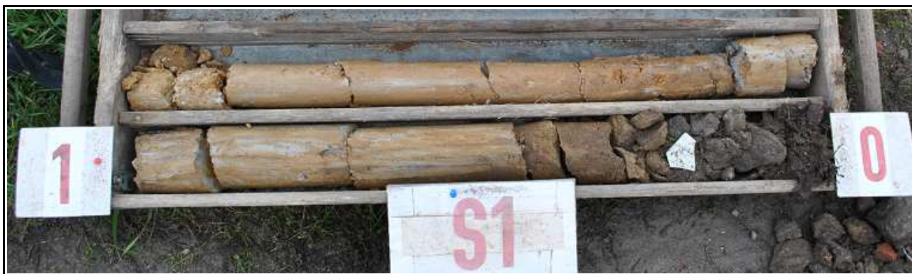
Obr.č. 2 : Pohled do vzorkovnice na geologický profil sondy S1, hluboké 2,0 m. Zpevňující vrstva cesty je 300 mm mocná tvořená směsí stav. odpadu a výkopové zeminy. Nasedá na šedohnědý písčito-hlinitý jíl, pevný, od 0,5 m žlutorezavý- světle šedě mramorovaný jíl s vysokou plasticitou , pevný, s rozptýleným štěrčkem do vel. 5 mm, ojed. 1 až 2 cm . Podzemní voda se v sondě neprojevila.
