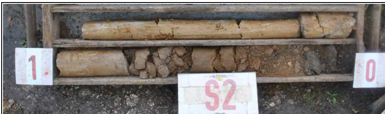
Obr.č. 4 : Pohled na geologický profil sondy S2, hluboké 1,9 m. Povrch cesty zpevňuje štěrkový písek tl. 150 mm , zazemněný , nasedající na písek hlinitý, pevný, drobně úlomkový. Od 0,7 m dokumentován žlutorezavý- světle šedě mramorovaný jíl , pevné konzistence, s rozptýleným štěrčkem do 5 mm, ojed. polozaob. úl. vel. 1 až 2 cm . Podzemní voda se v sondě neprojevila.
