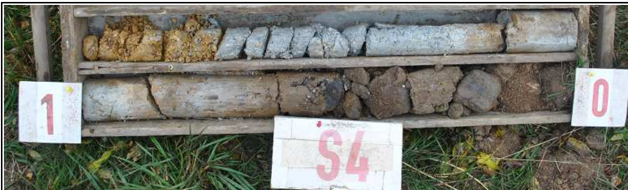
Obr.č. 8 : Pohled na geologický profil sondy S4, hluboké 2,0 m. Pod zazemněnou drnovou vrstvou zastižena konstrukce původní cesty mocnosti 450 mm, tvořená stabilizujícím kamenivem a prolohami jílovité hlíny. V hloubce 0,6 m zastižena světle modrošedý jíl písčitý, od 1,2 m písek jílovitý, pevný, s živcovou drtí do 5 mm, ojed. valoun 1 cm. Od 1,7 m dokumentováno žlutorezavé eluvium žuly, pevnostní třídy R6. Podzemní voda se v sondě neprojevovala.
