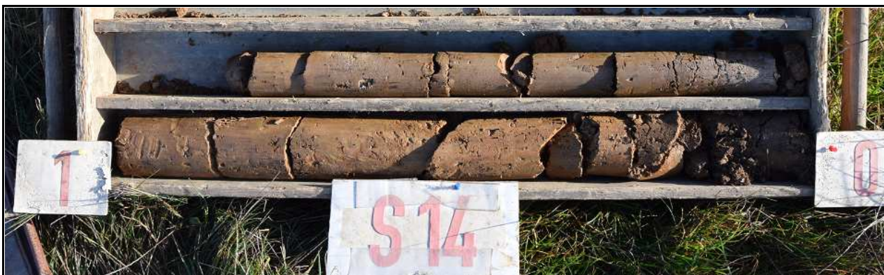
Obr.č. 28: Pohled na geologický profil vrtu S14, hluboký 1,8 m. Vrstva orniční hlíny je 0,2 m mocná a nasedá na rezavohnědý písčitý jíl, pevný, slabě štěrkovitý. Přítomnost podzemní vody se ve vrtu neprojevila.
