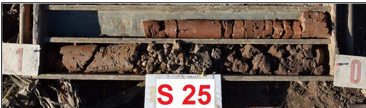
Obr.č. 51: Pohled na geologický profil vrtu S25, hluboký 1,6 m. Orniční hlína 0,35 m mocná nasedá na hlinitý písek, pevný, od 0,7 m šedorezavý písek jílovitý se štěrkem do vel. 4 cm. Hloubení ukončeno patrně na povrchu rudohnědého jílovce, velmi pevného. Přítomnost podzemní vody se ve vrtu neprojevila.
