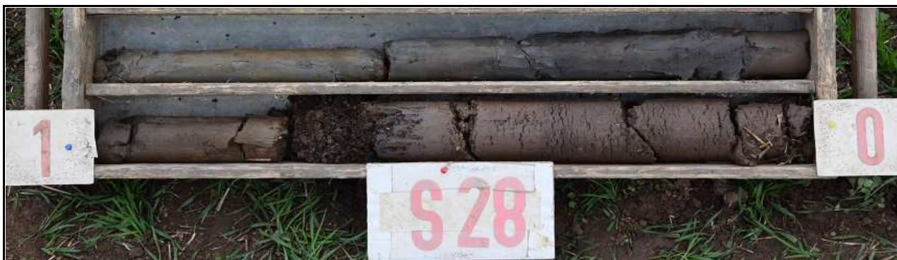
Obr.č. 57: Pohled na geologický profil vrtu S28, hluboký 2,0 m. Orniční hlína 0,3 m mocná nasedá na rezavohnědý písčité jíl, tuhý až pevný, od 0,9 m jíl měkký. Od úrovně 1,5 m dokumentován splachový modrošedý-rezavě mramorovaný jíl tuhý, s rozptýlenou křemennou drtí do vel. 5 mm. Hladina podzemní vody ustálena 1,5 m pod terénem.
