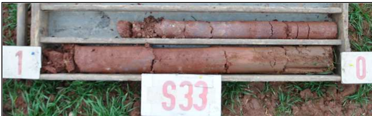
Obr.č. 67: Pohled na geologický profil vrtu S33, hluboký 1,7 m. Vrstva slabě humusovitě hlína je 0,2 m mocná a nasedá na rudofialový jílovitý písek, pevný, šterkovitý. Přítomnost podzemní vody nezastižena.
