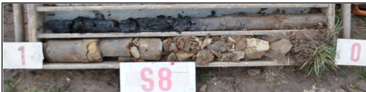
Obr.č. 16: Pohled na geologický profil vrtu S8, hluboký 2,0 m. Těleso cesty je 0,8 m mocné, tvořené hlinitou sutí s pískovcovým kamenivem. Kvartérní pokryv tvoří písčitá hlína, pevná, nasedající v hloubce 1,2 m na hlinitý jíl tuhý, od 1,5 m jíl organ, velmi měkký. Podzemní voda ustálena 1,45 m pod terénem.
