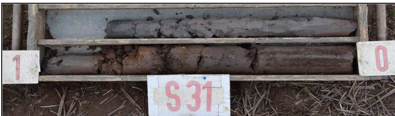
Obr.č. 63: Pohled na geologický profil vrtu S31, hluboký 1,8 m. Orniční hlína 0,3 m mocná nasedá na rudohnědou písčito-jílovitou hlínu, tuhou, s rozptýlenou ostrohr. drtí do 5 mm. Od úrovně 0,8 m zastižen šedý jíl velmi měkký. Přítomnost podzemní vody nebyla zastižena.
