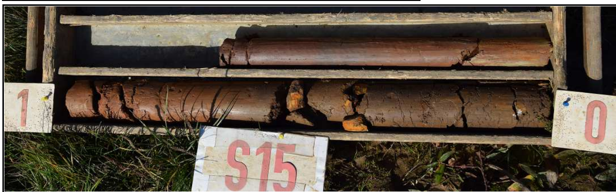
Obr.č. 30: Pohled na geologický profil vrtu S15, hluboký 1,7 m. Vrstva orniční hlíny je 0,3 m mocná a nasedá na šedohnědou jílovitou hlínu, pevnou, s úlomky pískovce. Od úrovně 0,5 m dokumentován rudohnědý písčito-hlinitý jíl, tuhý až pevný. Hloubení ukončeno v rudohnědém jílovci pevné až tvrdé konzistence.
