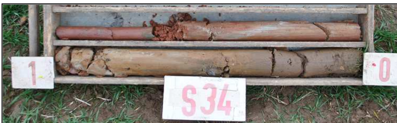
Obr.č. 69: Pohled na geologický profil vrtu S34, hluboký 2,0 m. Vrstva slabě humusovité hlíny je 0,2 m mocná a nasedá na jíl hlinitý, slabě štěrkovitý, pevný. V úrovni 1 m dokumentován pestrý jíl písčitý, tuhý až pevný, s ojed. štěrčíkem, na bázi v úrovni 1,5-1,7 m rudohnědý písek štěrkovitý. Hloubení ukončeno v rudohnědém jílovcí velmi pevné konzistence. Přítomnost podzemní vody se ve vrtu neprojevila.
