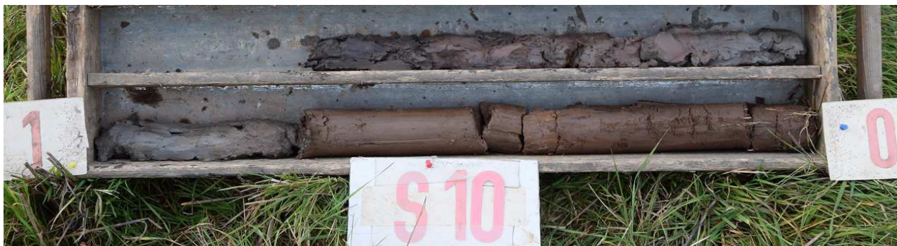
Obr.č. 20 : Pohled na geologický profil vrtu S10, hluboký 1,7 m. Pod rudohnědou prachovitou hlínou, pevnou zastížen v hloubce 0,5 m jíl hlinitý, tuhý – od 0,7 m modrošedý jíl měkký, od 1,5 m s černým organogenním jílem velmi měkké konzistence. Hladina podzemní vody ustálena 0,65 m pod terénem.
