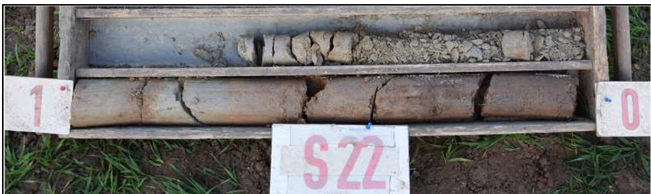
Obr.č. 45 : Pohled na geologický profil vrtu S22, hluboký 1,7 m. Orniční hlína 0,30 m mocná nasedá na písčité jíl pevný, od 0,6 m bělošedý písek jílovitý, s ostr. drtí. Od úrovně 1 m dokumentován zvětralý pískovec velmi uhlý, od 1,5 m stmelený. Přítomnost podzemní vody se ve vrtu neprojevila.
