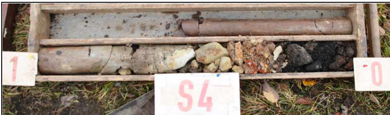
Obr.č. 8: Pohled na geologický profil vrtu S4, hluboký 1,5 m. Násypové těleso vozovky je 0,7 m mocné, složené z černé štěrkodrtě mocnosti 300 mm a nesourodé vrstvy hlíny, cihel a kameniva, založené do stabilizační vrstvy z pískovcových kamenů. Kvartérní pokryv tvoří hlinitý jíl, pevný, s úlomky pískovce, od 1,1 m s přechodem do rudohnědého jílovce, pevné až tvrdé konzistence. Podzemní voda se neprojevila.
