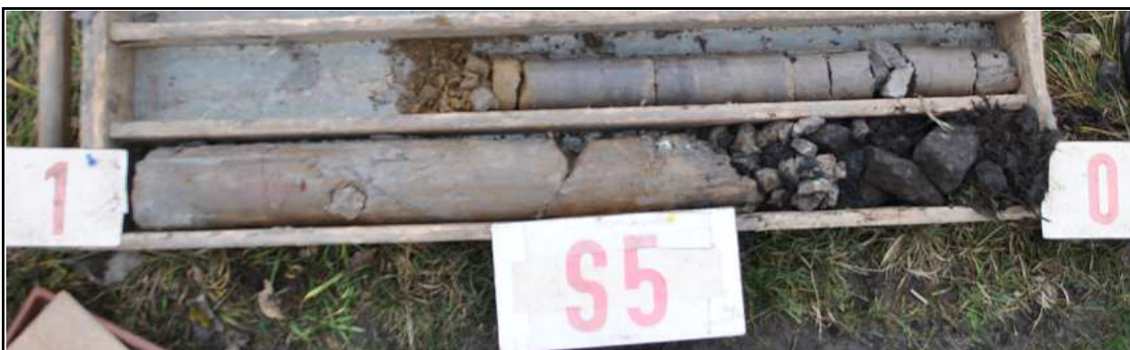
Obr.č. 10: Pohled na geologický profil vrtu S5, hluboký 1,6 m. Násypové těleso vozovky je 0,4 m mocné , složené z černé štěrkodrtě mocnosti 300 mm a založené do stabilizační vrstvy z makadamové drtě 32-63. Kvartérní pokryv tvoří šedorezavý hlinitý jíl, pevný, s úlomky pískovce, od 1,0 m s přechodem do šedého-rezavě páskovaného jílovce, pevné konzistence. Hloubení ukončeno ve žlutorezavém pískovci, velmi ulehlém, vrstevnatě rozpadavém. Podzemní voda se ve vrtu neprojevila.
