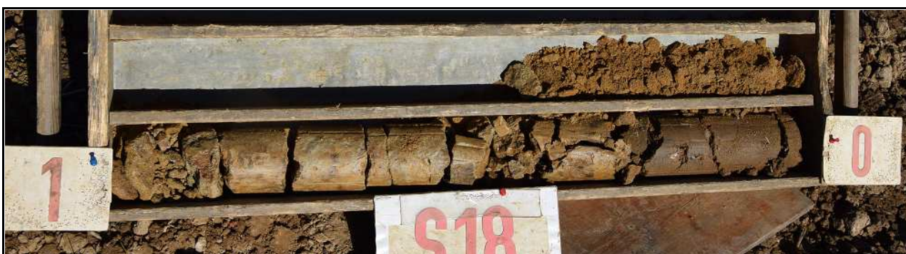
Obr.č. 36: Pohled na geologický profil vrtu S18, hluboký 1,4 m. Vrstva orniční hlíny je 0,25 m mocná a nasedá na žlutorezavý písčité jíl, pevný, slídnatý. V hloubce 1 m dokumentován hnědorezavý zvětralý pískovec, povahy jemně až středně zrnitého písku, velmi ulehlého. Přítomnost podzemní vody se ve vrtu neprojevila.
