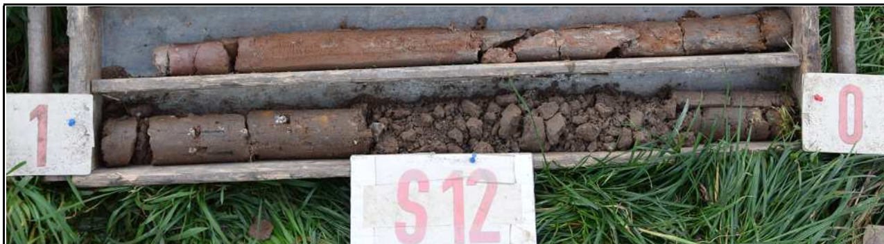
Obr.č. 24 : Pohled na geologický profil vrtu S12, hluboký 1,9 m. Splavený horizont slabě humusovité hlíny nasedá v hloubce 0,6 m na vrstvu svahové hlíny písčité, pevné, s ostrrohr. úlomky. Od úrovně 1,0 m dokumentován pestrý jílnitý, pevný, s úl. pískovce. Přítomnost podzemní vody se ve vrtu neprojevila.
