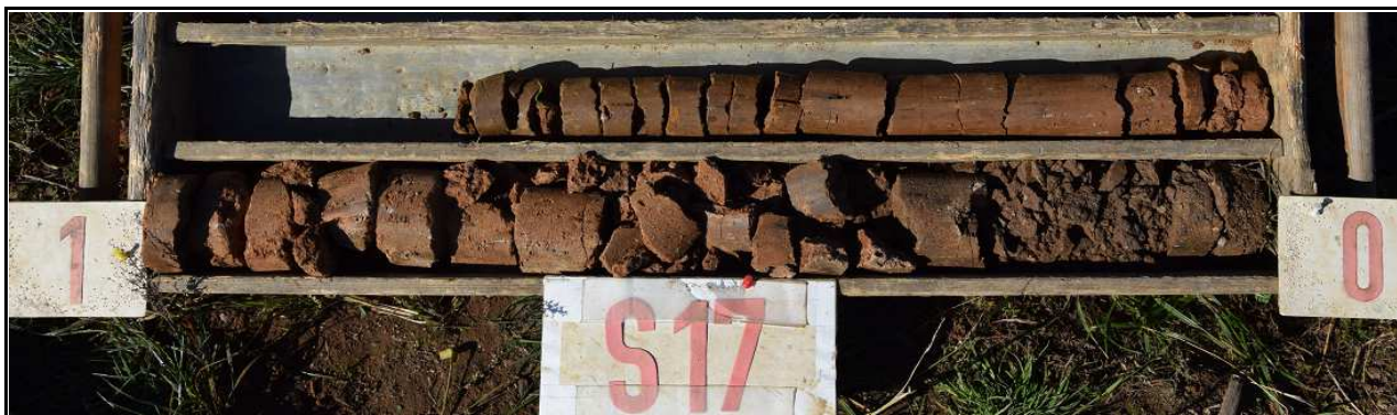
Obr.č. 34 : Pohled na geologický profil vrtu S17, hluboký 1,7 m. Vrstva orniční hlíny je 0,25 m mocná a nasedá na souvislou vrstvu svahového rezavohnědého hlinitého písku, soudržného, pevné konzistence, s příměsí ostrohr. drtě a závalky písčitého jílu. Přítomnost podzemní vody se ve vrtu neprojevila.
