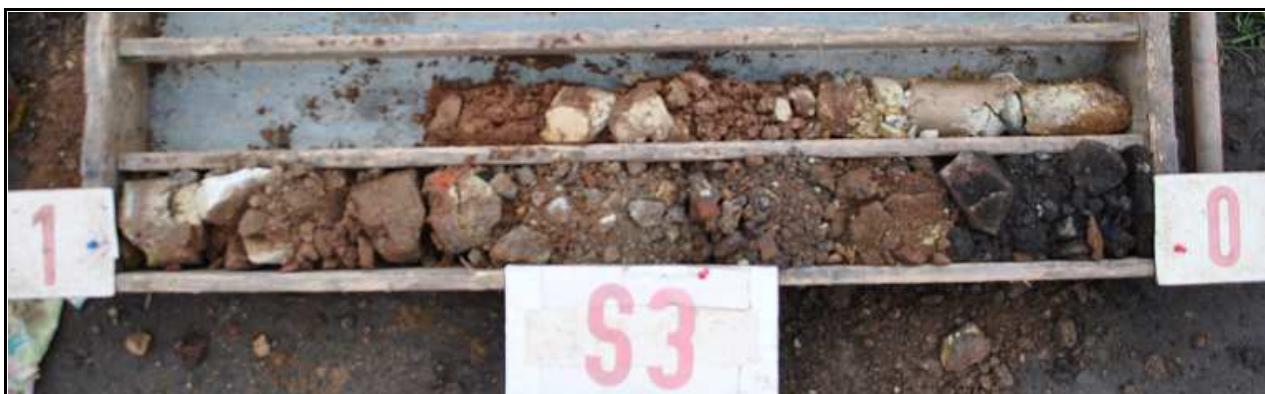
Obr.č. 6 : Pohled na geologický profil vrtu S3, hluboký 1,7 m. Násypové těleso vozovky dosahuje výšky 1,6 m a je vrstvené z lomové štěrkodrtě tl. 200 mm, hlouběji jílovito-štěrkovitého písku, velmi ulehlého, s příměsí kameniva a cihelné drtě mocnosti 0,5 m. Spodní část násypu je provedena z hlinitého písku, ulehlého, obsahující kameny pískovce, s prolohou štěrkovité hlíny, pevné konzistence v úrovni 1,0-1,5 m. Kvartérní pokryv tvoří hnědorezavý písek s jemnou příměsí, středně ulehlý, silně vlhký. Podzemní voda se projevila v úrovni 1,6 m, s následným ustálením 1,5 m pod terénem.
