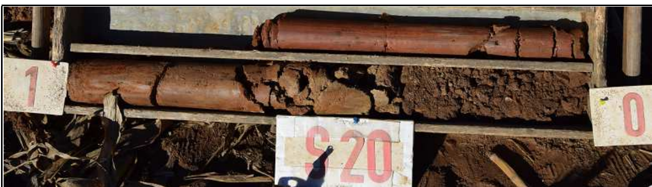
Obr.č. 41: Pohled na geologický profil vrtu S20, hluboký 1,6 m. Orniční hlína 0,30 m mocná nasedá na jílovitý písek, pevný, od 0,5 m rezavohnědý písčito-hlinitý jíl, pevný, s příměsí drobných ostrohr. úlomků. Od úrovně 1 m dokumentován rudohnědý jílovec pevné konzistence. Přítomnost podzemní vody se ve vrtu neprojevila.
