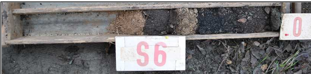
Obr.č. 12: Pohled na vrt S6, hluboký 0,65 m. Těleso lesní cesty je rekonstruováno vrstvou černé štěrkodrtě a škváry v tl. 400 mm . Původní povrch cesty tvořil hlinito-štěrkovitý písek, zazemněný, s původním drnovým krytem. Hloubení ukončeno v podloží tvořeném světle hnědým hlinitým pískem, ulehlém.
