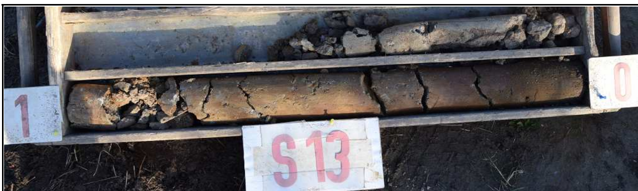
Obr.č. 26: Pohled na geologický profil vrtu S13, hluboký 1,5 m. Pod slabou vrstvou orniční hlíny leží hlína písčitá, pevná, nasedající v úrovni 0,4 m na šedorezavý jíl hlinito-písčitý, pevný, s valouny štěrku. Od 1,0 m dokumentován bělošedý písek velmi ulehlý, přecházející v 1,3 m do písčitého jílovce pevné až tvrdé konzistence, v ruce držitelného. Přítomnost podzemní vody se ve vrtu neprojevila.
