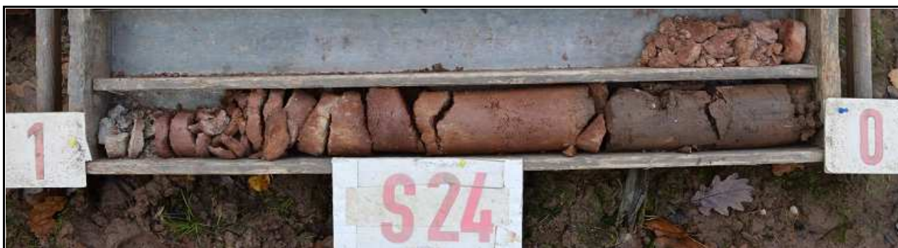
Obr.č. 49: Pohled na geologický profil vrtu S24, hluboký 1,2 m. Orniční hlína 0,25 m mocná nasedá na svahový písek jílovitý, pevný, s křemennou drtí, od 0,5 m s přechodem do pestrého vrstevnatého pískovce a jílovce, stmeleného , od 1 m až velmi málo pevného, třídy R5. Přítomnost podzemní vody se ve vrtu neprojevila.
