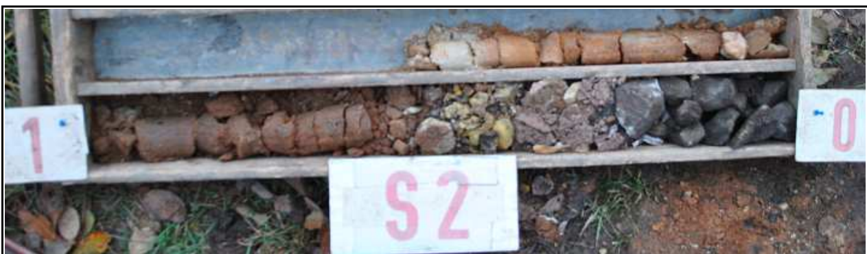
Obr.č. 4: Pohled na geologický profil vrtu S2, hluboký 1,5 m. Násypové těleso vozovky je 0,6 m mocné , složené z lomové štěrkodrtě tl. 250 mm a hlinito-štěrkovitého písku , velmi ulehlého, s úlomky pískovce. Kvartérní pokryv tvoří hlinitý od 1 m jílovitý písek, pevné konzistence, s valouny křemene. Hloubení ukončeno ve zvětralém bělavém pískovci, velmi ulehlém. Podzemní voda se ve vrtu neprojevila.
