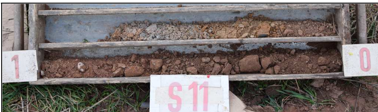
Obr.č. 22: Pohled na geologický profil vrtu S11, hluboký 1,7 m. Svrchní humusovitá hlína přechází do hlíny písčité, pevné, od 0,6 m s vrstvou svahového písku, slabě štěrkovitého. Od 1,3 m dokumentován písek slabě jílovitý, ulehlý, drobně štěrkovitý. Přítomnost podzemní vody se ve vrtu neprojevila.
