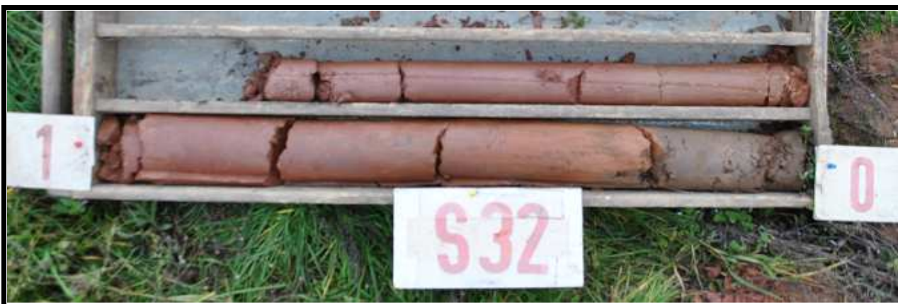
Obr.č. 65: Pohled na geologický profil vrtu S32, hluboký 1,8 m. Vrstva slabě humusovitě hlíny je 0,2 m mocná a nasedá rezavohnědý jíl tuhý až pevný, s rozptýlenou ostrohr. drtí do 10 mm. Od úrovně 0,9 m dokumentován rudohnědý jílovec, velmi pevné konzistence, v ruce drtitelný. Přítomnost podzemní vody se ve vrtu neprojevila.
