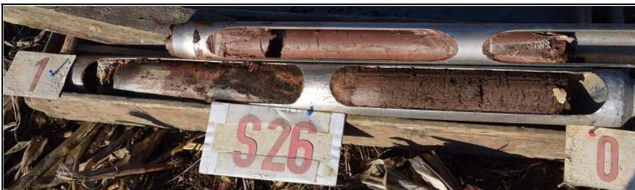
Obr.č. 53: Pohled na geologický profil vrtu S26, hluboký 1,7 m. Orniční hlína 0,35 m mocná nasedá na rudohnědý jílovitý písek, pevný, s křemennou drť do 5 mm. Od úrovně 0,5 m zastižen zvětralý pestrý písčité jílovec , hojně slídnatý, hlouběji od 1,5 m rudohnědý jílovec pevné konzistence. Přítomnost podzemní vody se ve vrtu neprojevila.
