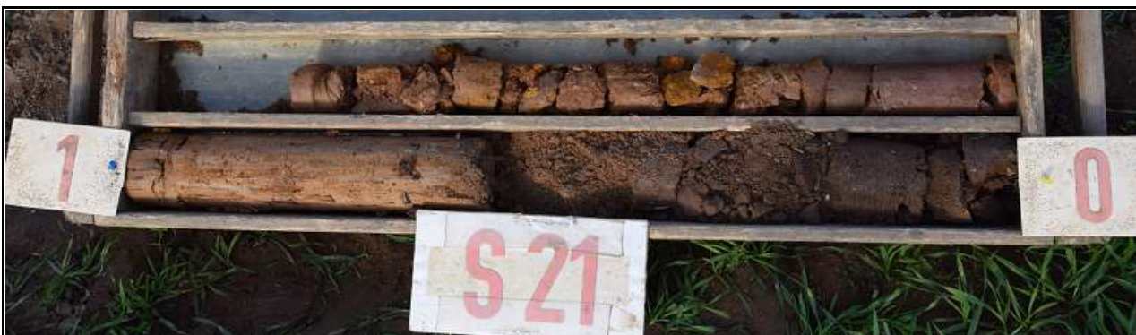
Obr.č. 43: Pohled na geologický profil vrtu S21, hluboký 1,8 m. Orniční hlína 0,35 m mocná nasedá na hlinitý písek, středně uhlý. V úrovni 0,6 m leží rezavohnědý až rudohnědý písčito-hlinitý jíl, pevný, s příměsí křemen. drtě do 5 mm a prolohou jílovitého písku, šterkovitého, pevného v hloubce 1,3-1,7 m. Přítomnost podzemní vody se ve vrtu neprojevila.
