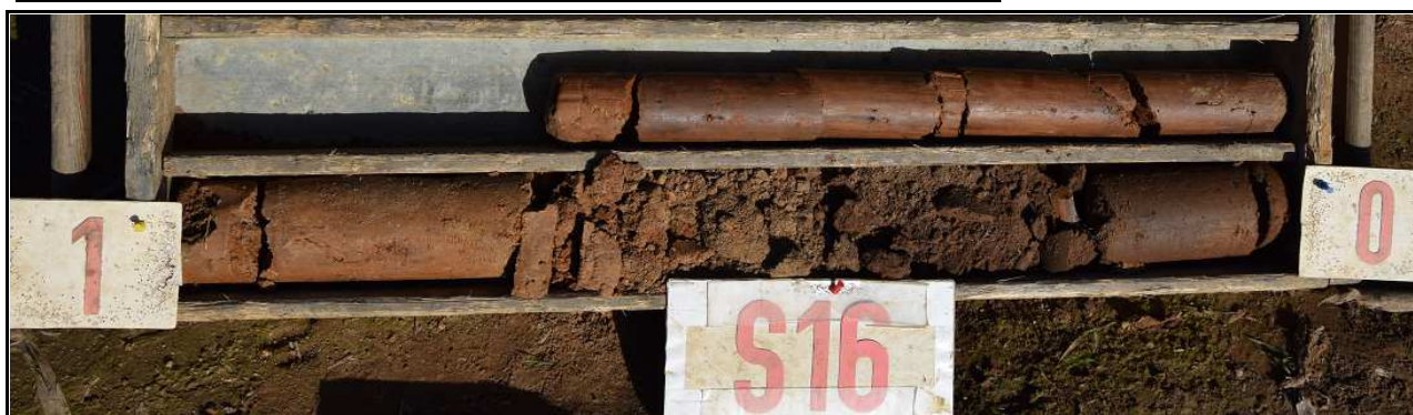
Obr.č. 32: Pohled na geologický profil vrtu S16, hluboký 1,6 m. Vrstva orniční hlíny je 0,25 m mocná a nasedá na rezavěhnědou písčito-jílovitou hlínu, pevnou, s příměsí drobných ostrohr. úlomků. V hloubce 0,5-1,0 m zastižen žlutohnědý písek jílovitý, soudržný pevný. Od úrovně 1,0 m dokumentován rudohnědý jílovec pevné až tvrdé konzistence. Přítomnost podzemní vody se ve vrtu neprojevila.
