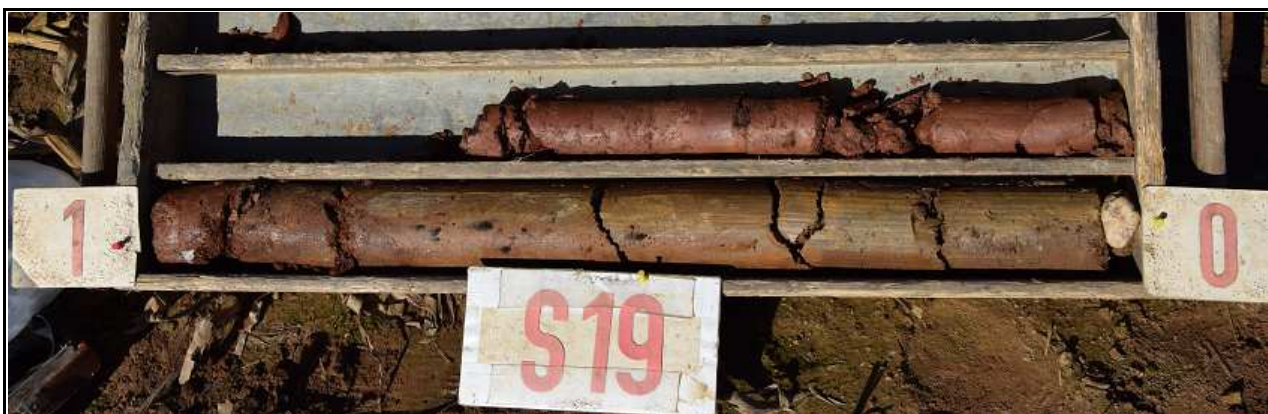
Obr.č. 39: Pohled na geologický profil vrtu S19, hluboký 1,7 m. Vrstva orniční hlíny 0,25 m mocná a nasedá na rezavěhnědý písčito-hlinitý jíl, pevný, s příměsí drobných ostrohr. úlomků, na bázi pokryvu 0,8-1,0 m písek hlinitý, se štěrkem. Od úrovně 1,0 m dokumentován rudohnědý jílovec pevné až tvrdé konzistence. Přítomnost podzemní vody se ve vrtu neprojevila.
