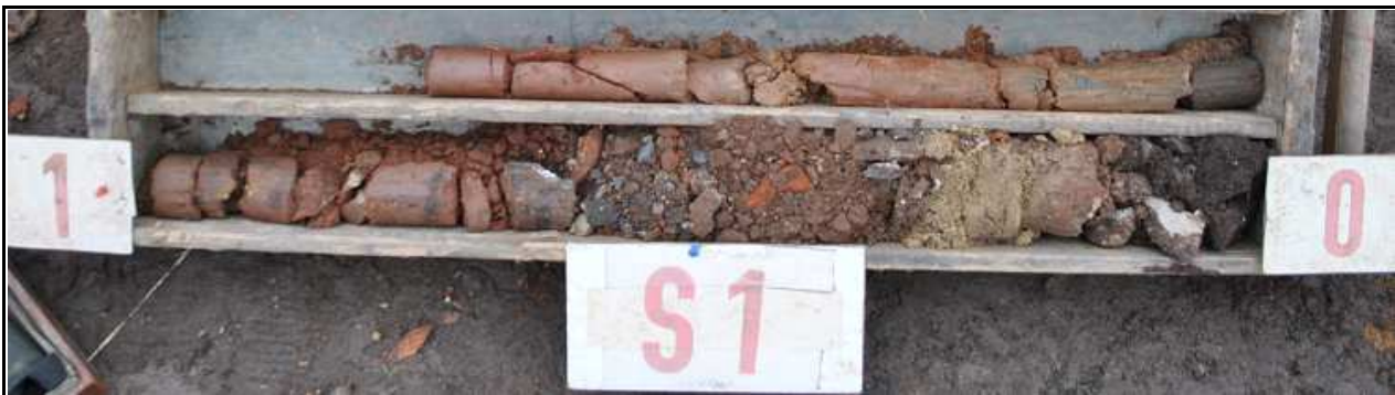
Obr.č. 2: Pohled do vzorkovnice na geologický profil vrtu S1, hluboký 1,7 m. Násypové těleso vozovky je 0,7 m mocné , složené z krycí vrstvy černé štěrkodrtě a štěrkovitého písku, ulehlého, tl. 300 mm, nasedající na nesourodou vrstvu hlíny, cihel a kameniva, ve stavu ulehlém. Kvartérní pokryv tvoří hlinitý – od 1 m jílovitý písek, pevné konzistence. Rudohnědý podloží jílovec velmi pevné konzistence byl dokumentován od úrovně 1,5 m. Podzemní voda se ve vrtu neprojevila.
