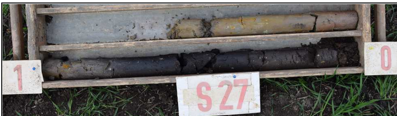
Obr.č. 55: Pohled na geologický profil vrtu S27, hluboký 1,6 m. Při povrchu zastížena černá rašelinná vrstva 0,7 m mocná, nasedá na rezavošedý splachový jíl hlinitý, s úlomky pískovce, od 1,3 m jíl písčité celkově tuhý, s proplásky jílovitého písku, drobně šterkovitého. Hladina podzemní vody ustálena 1,5 m pod terénem.
