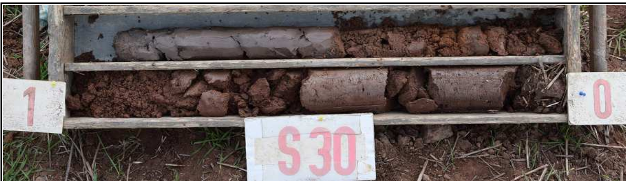
Obr.č. 61: Pohled na geologický profil vrtu S30, hluboký 1,9 m. Orniční hlína 0,3 m mocná nasedá na rudohnědou jílovitou hlínu, pevnou-drobivou, od 0,8 m s přechodem do slabě jílovitého písku, středně uhlého, drobně šterkovitého. Od úrovně 1,4 m zastižen šedý jíl velmi měkký. Hladina pozdemní vody ustálena 0,85 m pod terénem.
