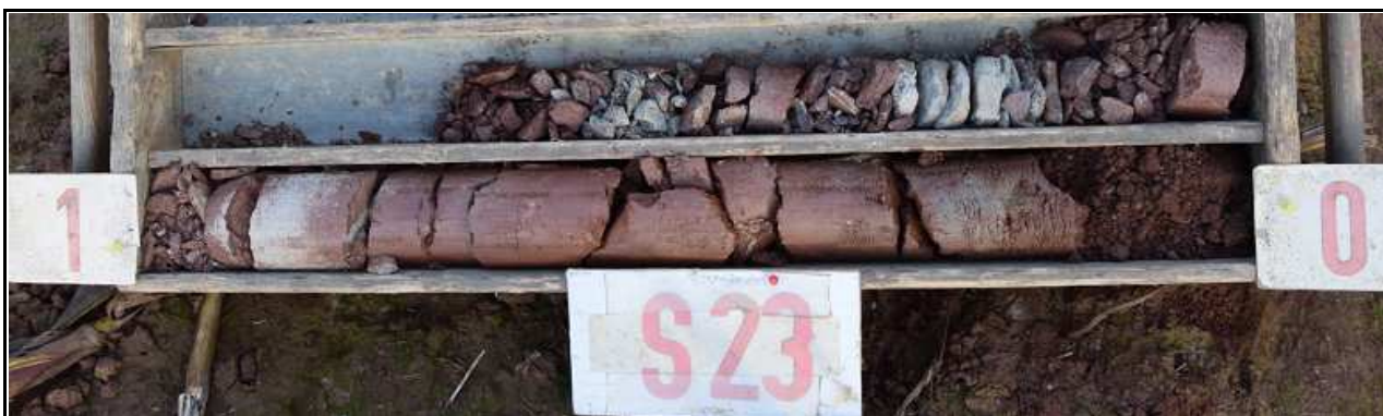
Obr.č. 47: Pohled na geologický profil vrtu S23, hluboký 1,7 m. Orniční hlína 0,20 m mocná nasedá na svahový jíl písčitohlinitý, pevný, od 0,5 m s přechodem do rudohnědého jílovce, pevné od 1 m tvrdé konzistence, s prolohami bělošedého pískovce, stmeleného. Přítomnost podzemní vody se ve vrtu neprojevila.
