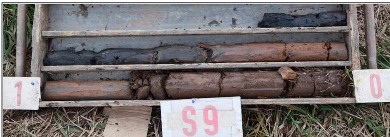
Obr.č. 18 : Pohled na geologický profil vrtu S9, hluboký 2,3 m. Kvartérní pokryv tvoří fluviální sediment tvořený svrchu jílovitou hlínou, od 0,4 m s přechodem do hlinitého jílu v celém profilu tuhé konzistence. Od hloubky 1,5 m zastížen černý organogenní jíl, velmi měkký. Po vyhloubení následoval vzestup hladiny na úroveň 0,75 m pod terén.
