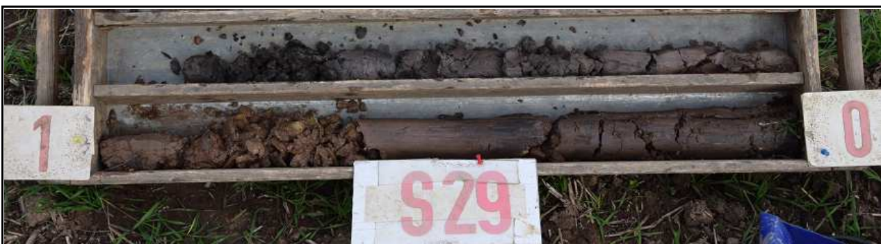
Obr.č. 59: Pohled na geologický profil vrtu S29, hluboký 1,9 m. Orniční hlína 0,3 m mocná nasedá na tmavěhnědý hlinito-písčitéjíl, tuhý až pevný, od 0,9 m jíl velmi měkký, s ukončením v organogenním náplavu. Hladina podzemní vody ustálena 0,7 m pod terénem, ovlivněná drenážním obsypem v hl. 0,7-0,9 m.
