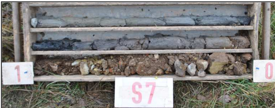
Obr.č. 14 : Pohled na geologický profil vrtu S7, hluboký 3,0 m. Těleso cesty je 0,9 m mocné, tvořené nesourodou vrstvou písčito-hlinité zeminy, pískovcového kameniva a stavebního odpadu (cihly, omítka), soudržné, pevné konzistence (konzolidované). Kvartérní pokryv tvoří fluvialní sediment tvořený svrchu hlinitým jílem tuhým – od 1,3 m měkké konzistence. Od hloubky 1,7 m zastížen černý organogenní jíl, velmi měkký, nasedající v hloubce 2,1 m na modrošedý jíl tuhý. Po vyhloubení následoval vzestup hladiny na úroveň 1,6 m pod terén, s následným zavalením stěny.
