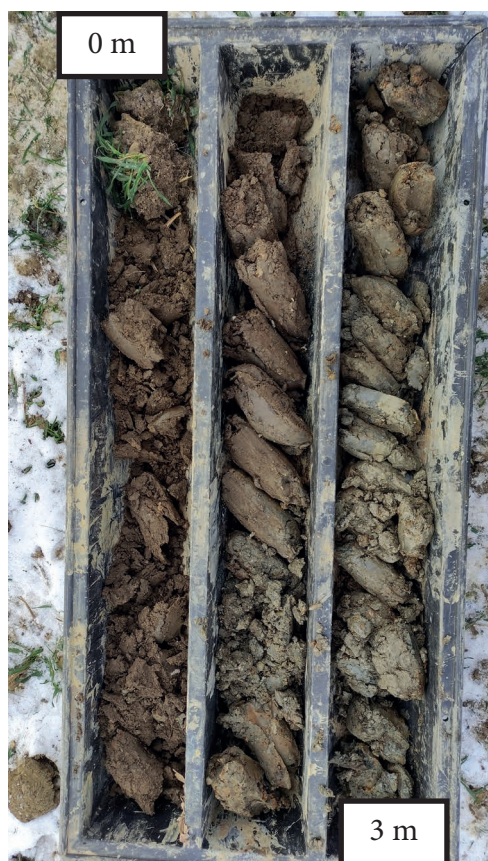
Geologický profil sondy S1
