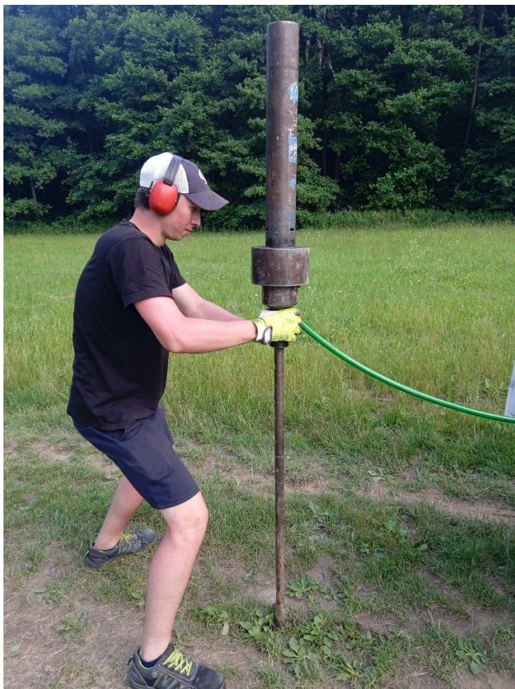
Foto7: Realizace střední penetrační sondy DPM 12
