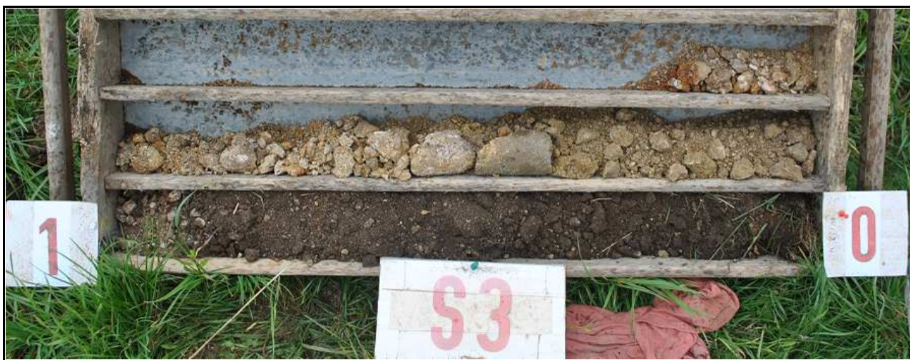
Obr.č. 6 : Pohled na geologický profil sondy S3, hluboké 2,2 m. Svrchní vrstva splavené humózní zeminy je 0,9 m mocná, kyprá, od hloubky 0,6 m s prolohami štěrkovitého písku. Nasedá na žlutošedý písek štěrkovitý, ulehlý , od 1,3 m s přechodem do zcela zvětralé žuly, pevnostní třídy R6, s ukončením hloubení v silně zvětralé, velmi málo pevné hornině, třídy R5. Podzemní voda se v sondě neprojevila.
