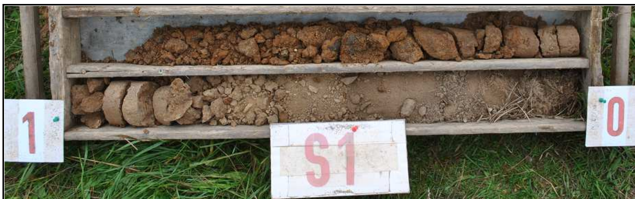
Obr.č. 2 : Pohled do vzorkovnice na geologický profil sondy S1, hluboké 1,9 m. Svrchní vrstva slabě humusovitě písčité hlíny je 0,25 m mocná a nasedá na hlinitý písek, ostrohr. úlomkovitý, od 0,7 m hlína prachovito-písčitá, pevná, s ojed. úlomky do 1 cm. V hloubce 1,1 m zastižen hnědorezavý jílnitý, pevný, s ostrohr. úlomky žuly do vel. 3 cm. Podzemní voda v sondě nezastižena.
