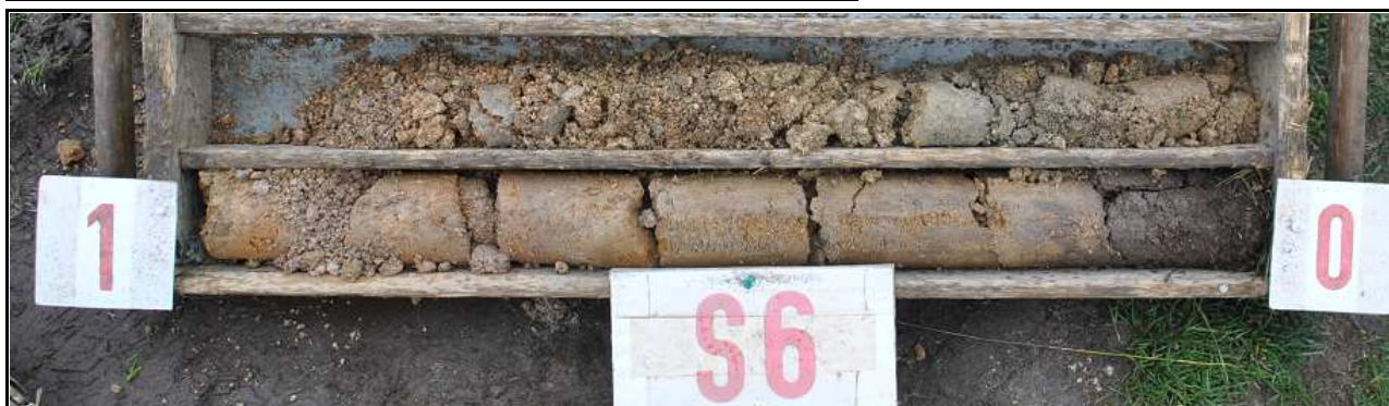
Obr. č. 10 : Pohled na geologický profil sondy S6, hluboké 1,9 m. Svrchní vrstva humózní zeminy je 0,25 m mocná a nasedá na jílovito-štěrkovitý písek , soudržný, s živcovou drtí do 1 cm. Od úrovně 0,5 m dokumentována světle žlutošedá zcela zvětralá žula, třídy R6, od 1,6 m s přechodem do silně zvětralé , hrubozrnné horniny, třídy R5. Podzemní voda se v sondě neprojevila.
