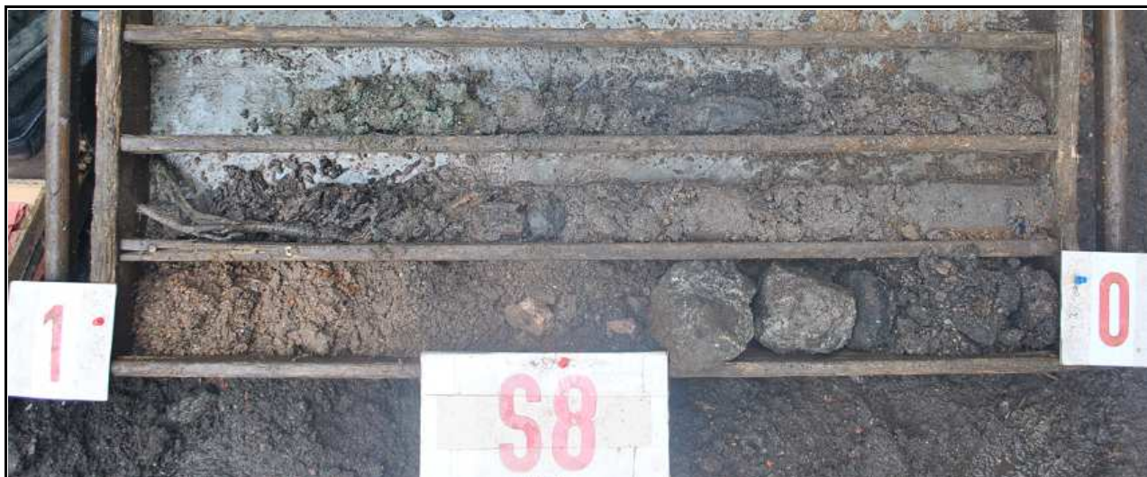
Obr. č. 14 : Pohled na geologický profil sondy S8, hluboké 2,8 m. Konstrukce cesty je 0,5 m mocná vrstvená z hrubého kamene , ulehlého, s černou hlinito-písčitou mezerou výplní , svrchu zazemněná . Založena je do žlutošedého štěrkovitého písku, střední ulehlosti, od 0,9 m písek hrubý se štěrčkem , málo ulehlý, vodou nasycený. O hloubky 1 m zastižen šedý písek jílovitý, měkký, se závalky měkkého jílu, od 1,6 m s prolohou splavené organické drtě, kypré. V hloubce 2 m přechází do šedého štěrkovitého písku, středně uhlého, zvodnělého. Hloubení ukončeno v šedozelené zcela zvětralé žule, třídy R6-R5, obsahující bělavé živce do vel. 2 cm. Podzemní voda naražená v úrovni 0,8 m s ustálením na téže úrovni. Pozn. Do hloubky 0,5 m obtížně dlátováno.
