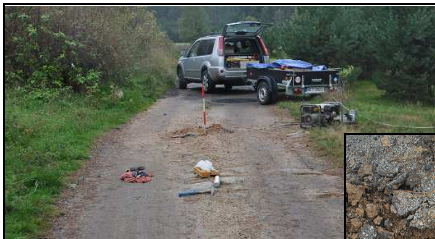
Obr.č. 7: Pohled na úvodní část polní cesty VPC 4R s kopanou sondou K5 a výchozy zvětralé žuly, pevnostní třídy R4. Pozn. Měření tvrdoměrem přineslo hodnotu pevnosti v prostém tlaku \sigma_c \sim 26 \text{ MPa} , odpovídající pevnostní třídě R3.
