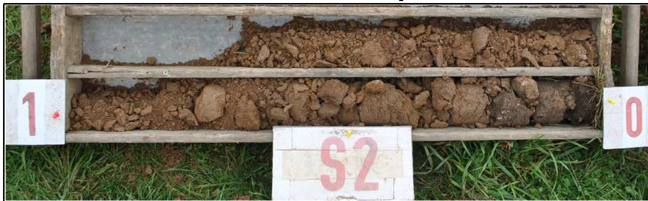
Obr.č. 4 : Pohled na geologický profil sondy S2, hluboké 1,7 m. Svrchní vrstva humusovitě hlíny je 0,2 m mocná a nasedá na hnědou jílovitou hlínu, pevnou, ostrohr. úlomkovitou. Podzemní voda nezastižena.
