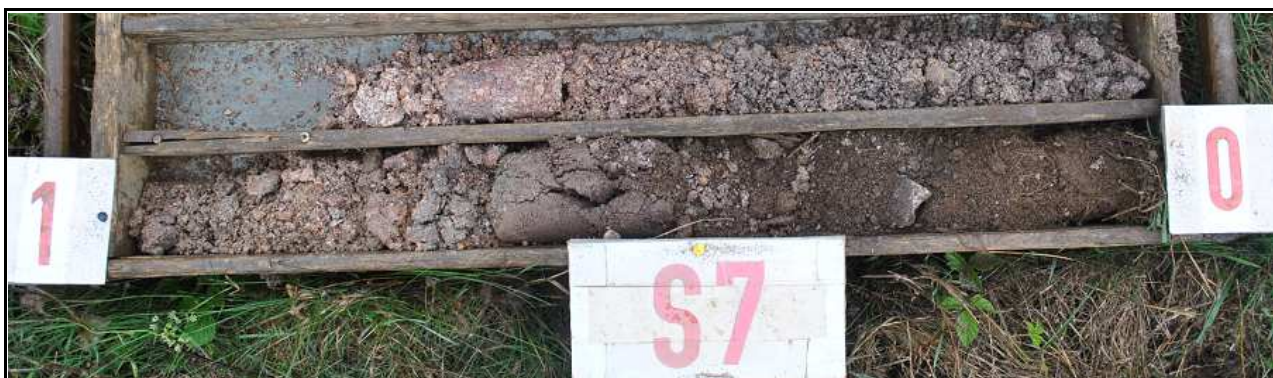
Obr. č. 12 : Pohled na geologický profil sondy S7, hluboké 1,8 m. Svrchní vrstva splavené humózní zeminy je 0,3 m mocná a překrývá původní kamenitou konstrukci cesty. V hloubce 0,5 m zastižen písek štěrkovitý, středně ulehlý. Zcela zvětralá žula dokumentována v hloubce 0,7 m, od 1,5 m s přechodem do silně zvětralé, velmi málo pevné, hrubozrnné, s vyrostlicemi narůžovělých živců, třídy R5. Podzemní voda naražená v úrovni 1,4 m s ustálením 1,15 m pod terénem.
