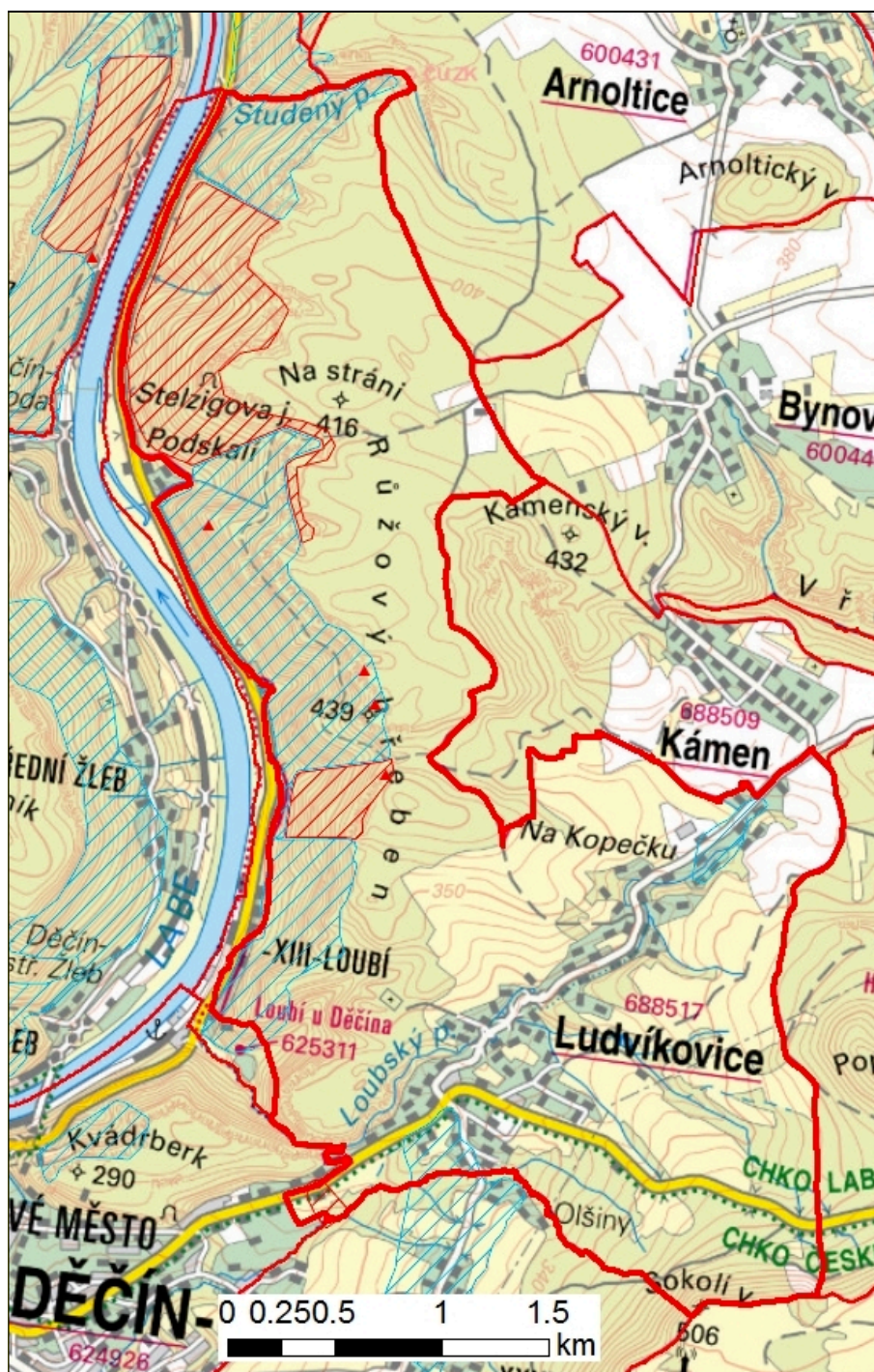
Obr. 3. Distribuce svahových nestabilit v katastrálním území Ludvíkovice (silná červená linie). Legenda: červená šrafa – plošné nestability aktivní; modrá šrafa – plošné nestability neaktivní nebo dočasně uklidněné; červený trojúhelník – bodové nestability aktivní. Zdroj 1) : mapy.geology.cz/svahove_nestability/ .
