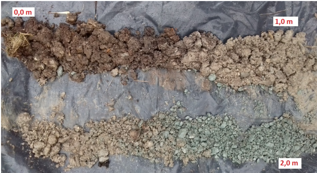
Foto 6: Vrtné jádro sondy P-6
