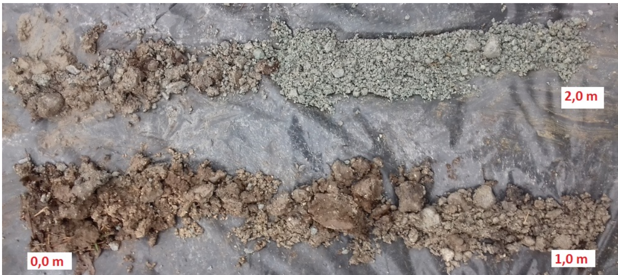
Foto 4: Vrtné jádro sondy P-4
