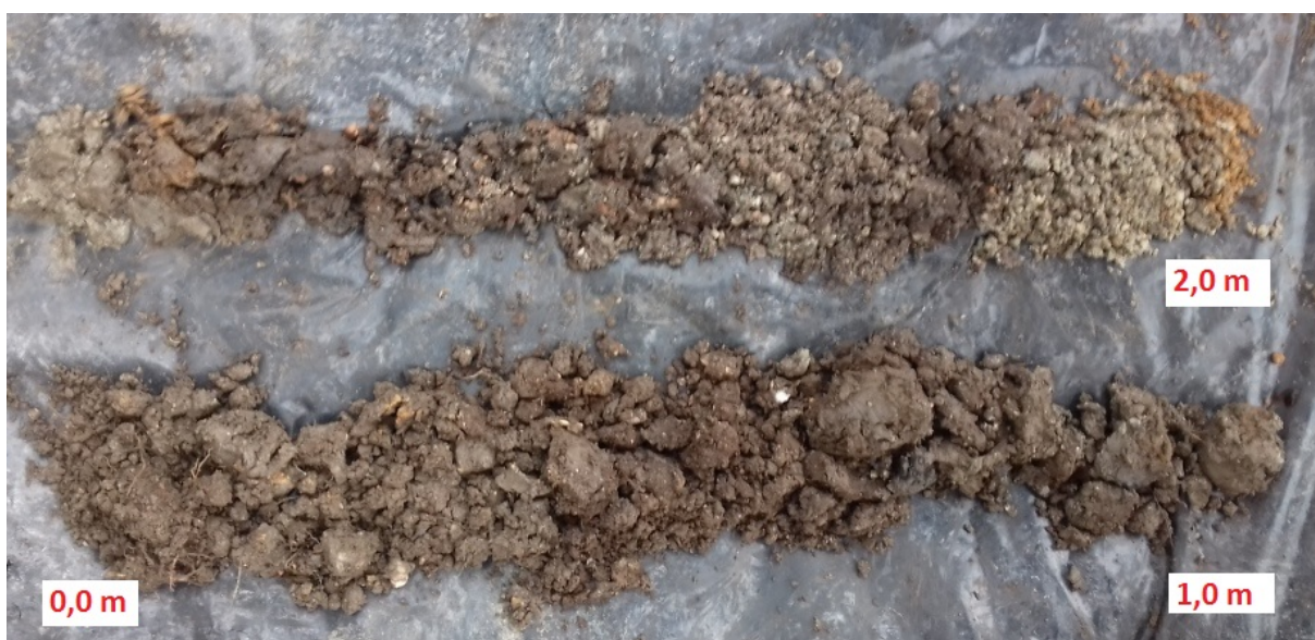
Foto 3: Vrtné jádro sondy P-2
