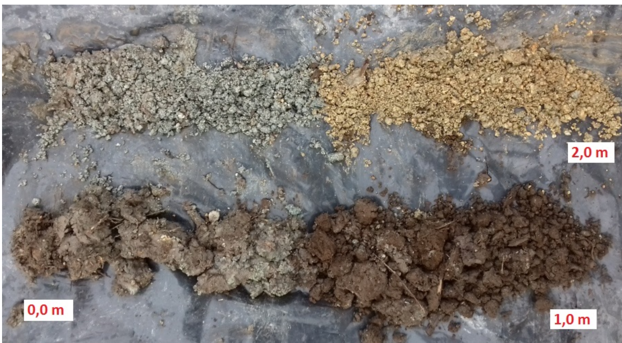
Foto 5: Vrtné jádro sondy P-5
