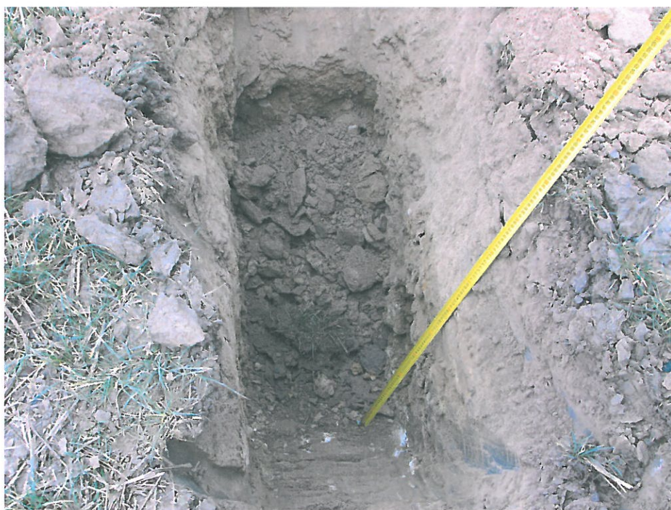
Sonda S4 – Rezavohnědý jemný písek, ukončený v pískovcové suti
