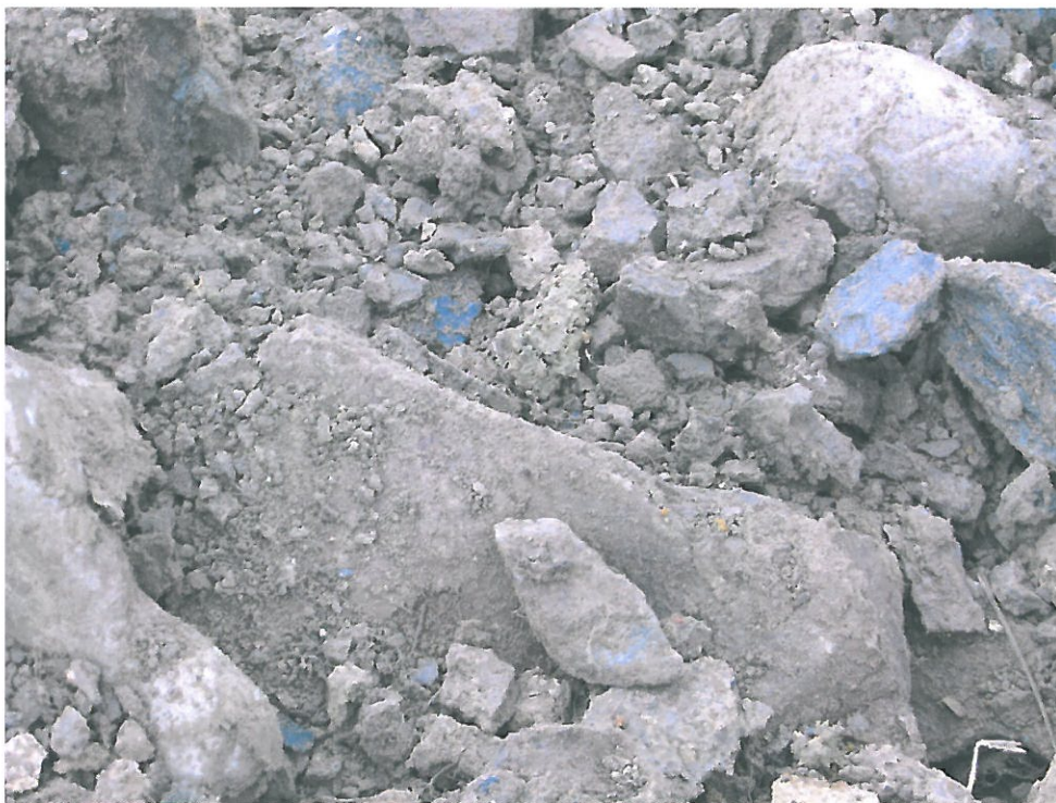
Sonda S5 – štěrky shora překryté starým zpevněním do 60cm
