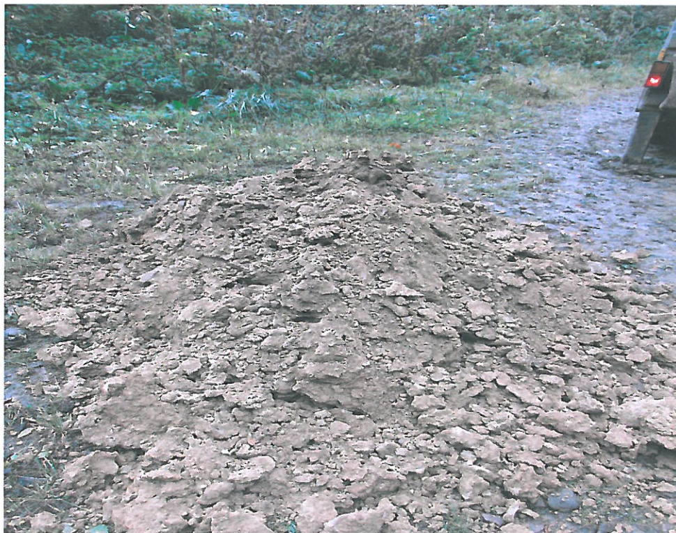
Sonda S8 – sutě 20x20, výplň jemný písek
