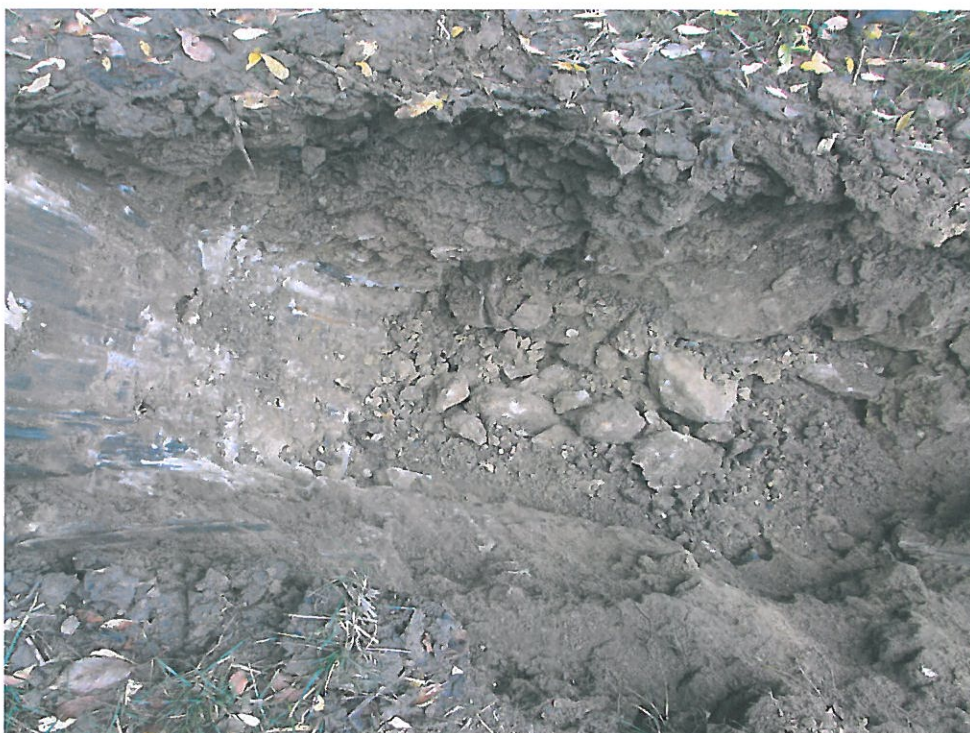
Sonda S8 – sutě 20x20, výplň jemný písek
