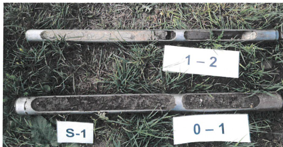
Obr. 3 Geologický profil sondy S-1
