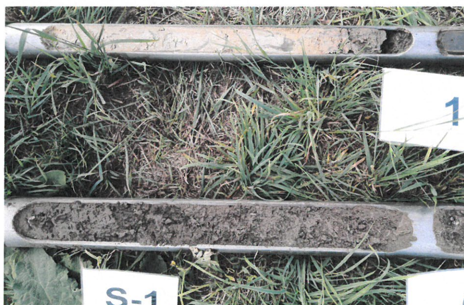
Obr.4 Geologický profil sondy S-1 – detail
