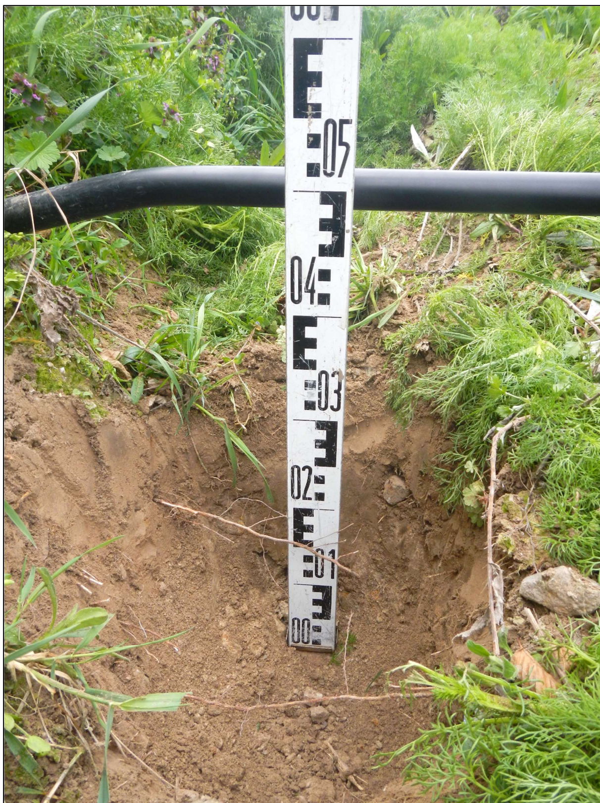
Obr. 8: Pedologický průzkum, sonda K2, mocnost ornice, vyznačena výška okol. terénu (0,5 m)
