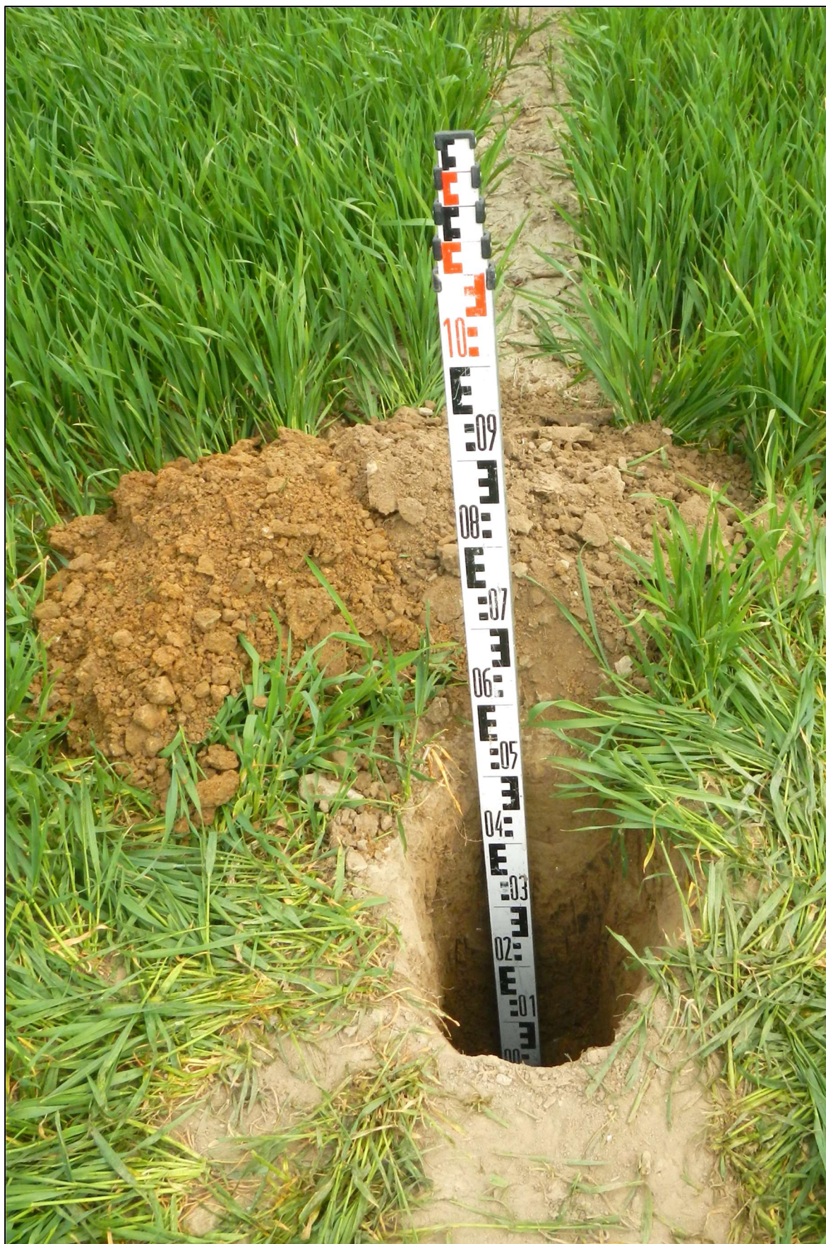
Obr. 6: Pedologický průzkum, sonda K1
