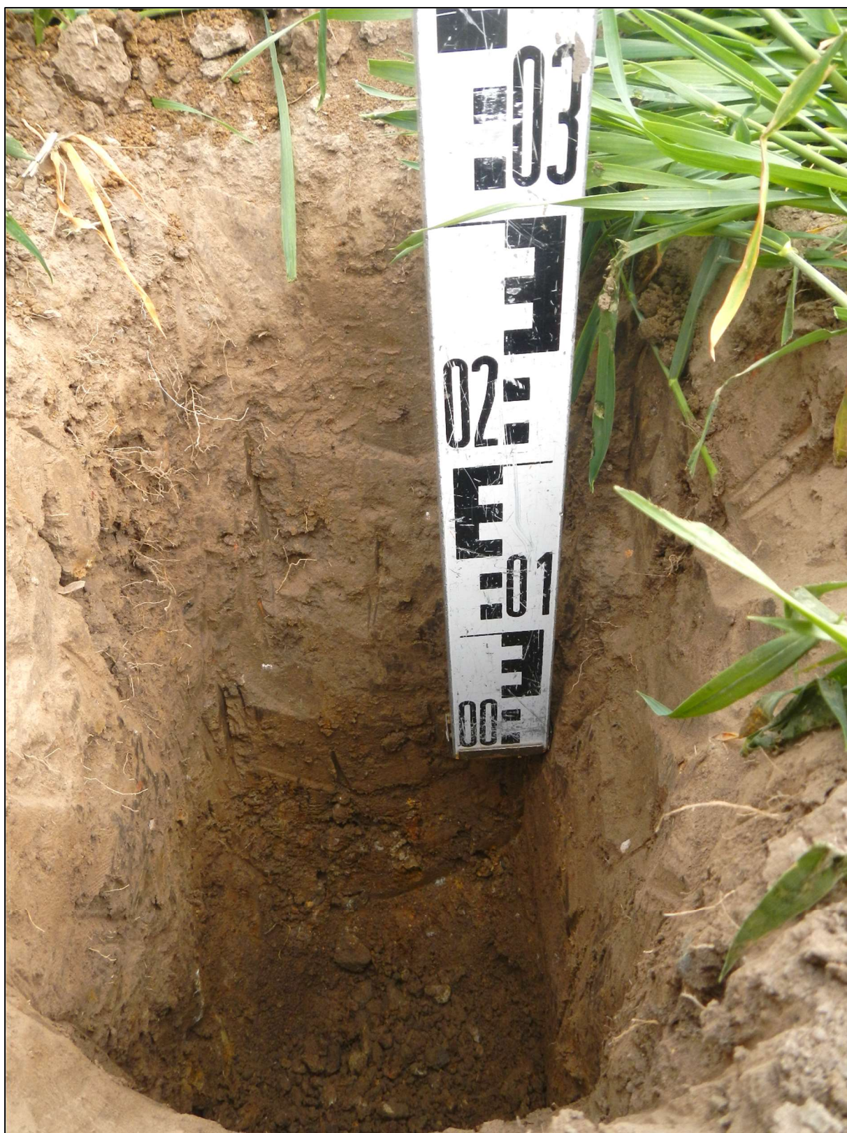
Obr. 7: Pedologický průzkum, sonda K1, detail – mocnost ornice (0,35 m)
