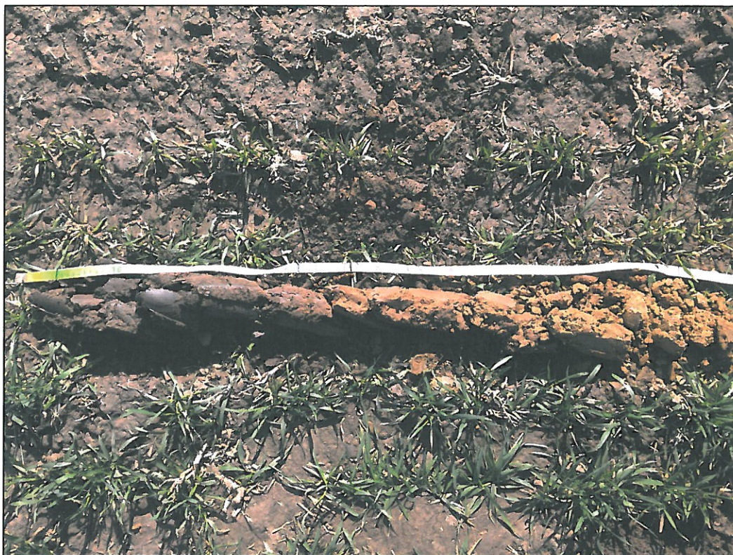
Foto č. 3: geologický profil sondy S20 – deluviální vrstvy sprašových hlín F6 CL
