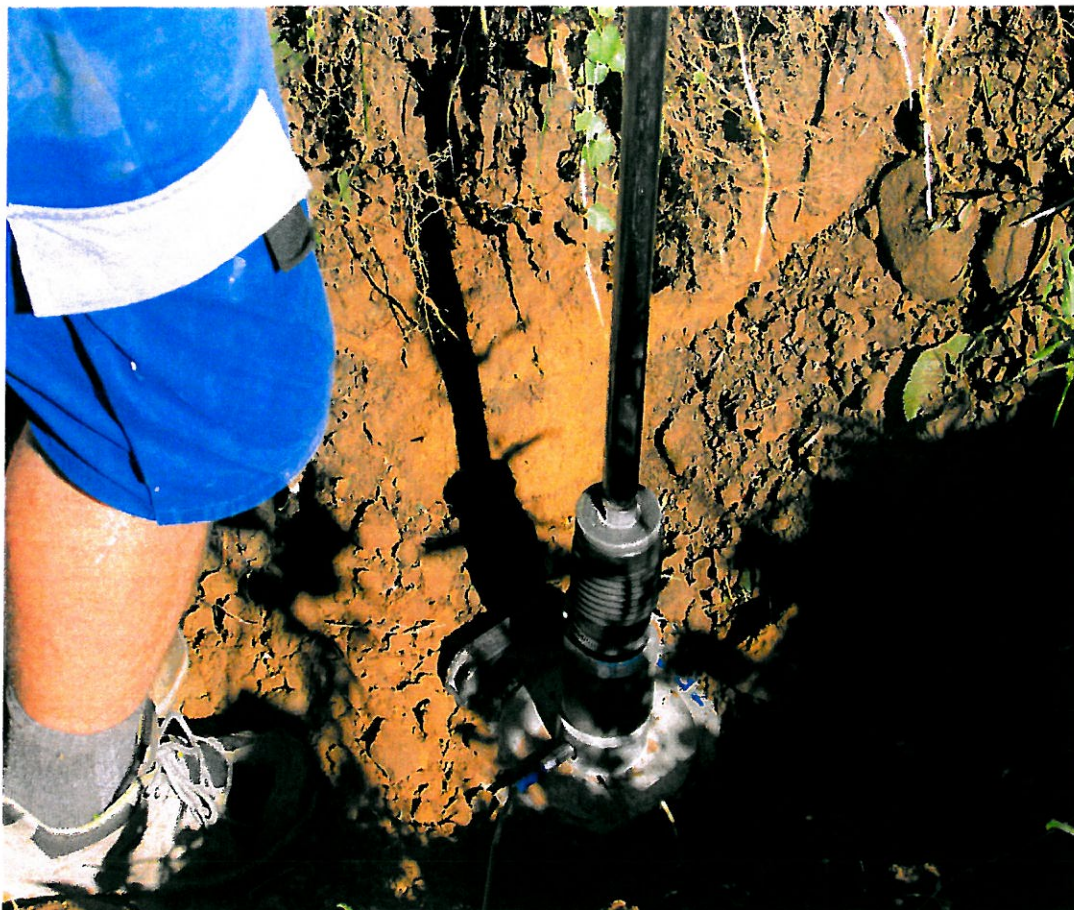
Měření cca v úrovni pláně (0.50m p.t.) prezentační foto rázové zkoušky
