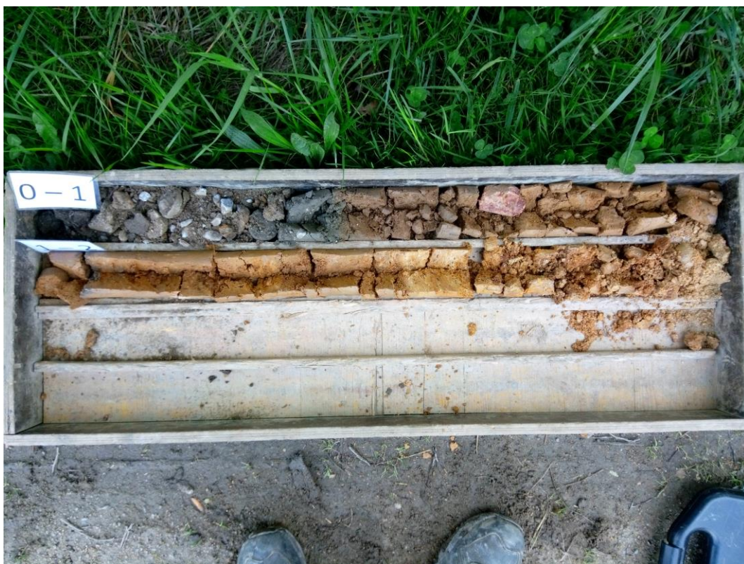
Obrázek 7: Jádro získané ze zarážené sondy ZS3 na lokalitě Dlouhá Stropnice
