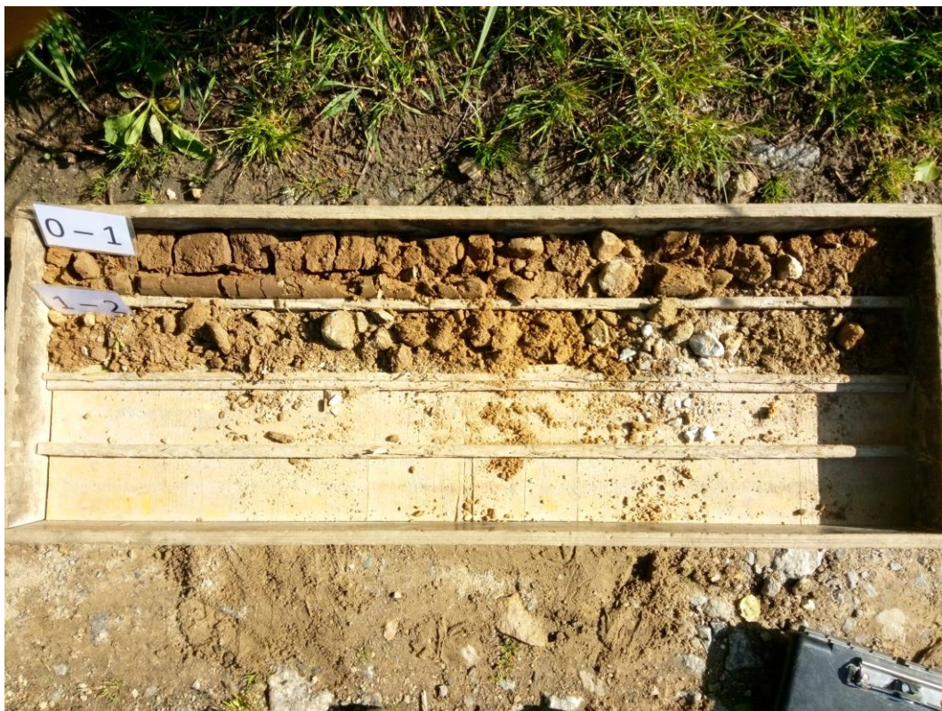
Obrázek 4: Jádru získané ze zarážené sondy ZS2 na lokalitě Dlouhá Stropnice
