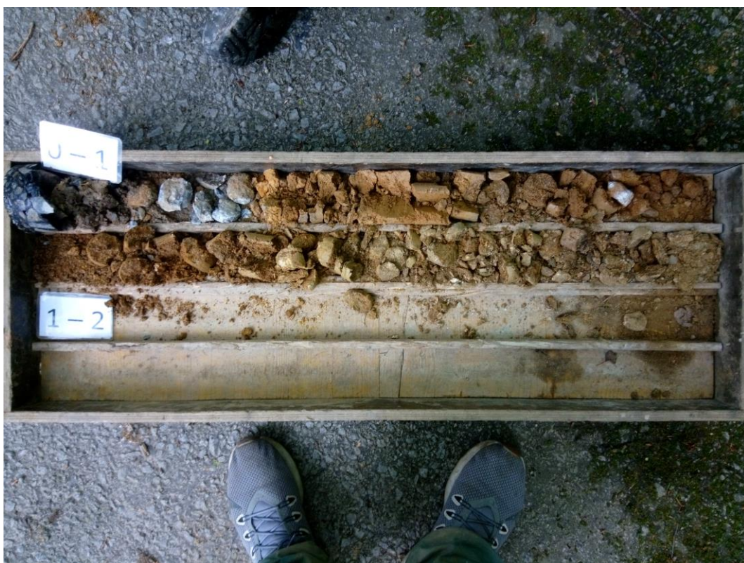
Obrázek 8: Jádro získané ze zarážené sondy ZS4 na lokalitě Dlouhá Stropnice
