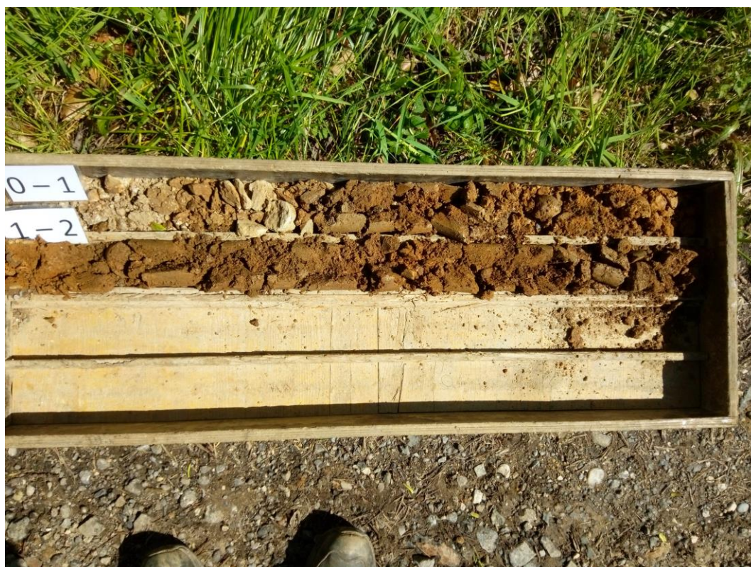
Obrázek 3: Jádru získané ze zarážené sondy ZS1 na lokalitě Dlouhá Stropnice
