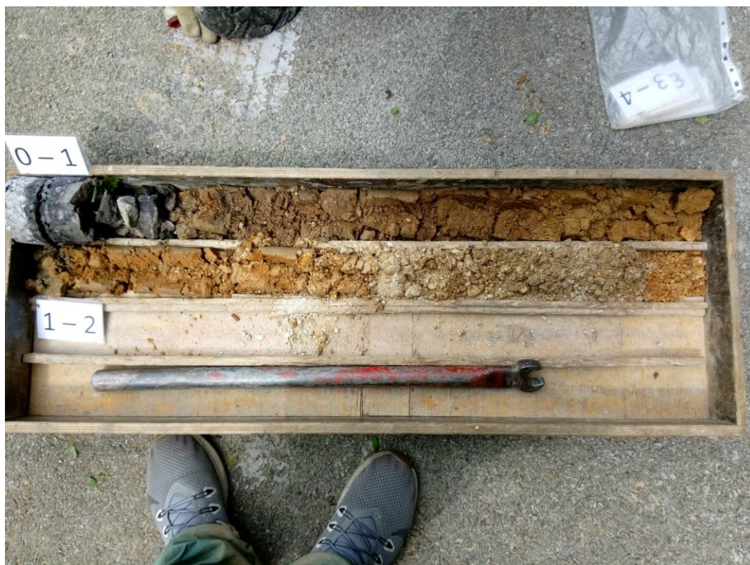
Obrázek 9: Jádro získané ze zarážené sondy ZS5 na lokalitě Dlouhá Stropnice
