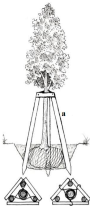
Obr. 1: Kotvení stromu s balem
