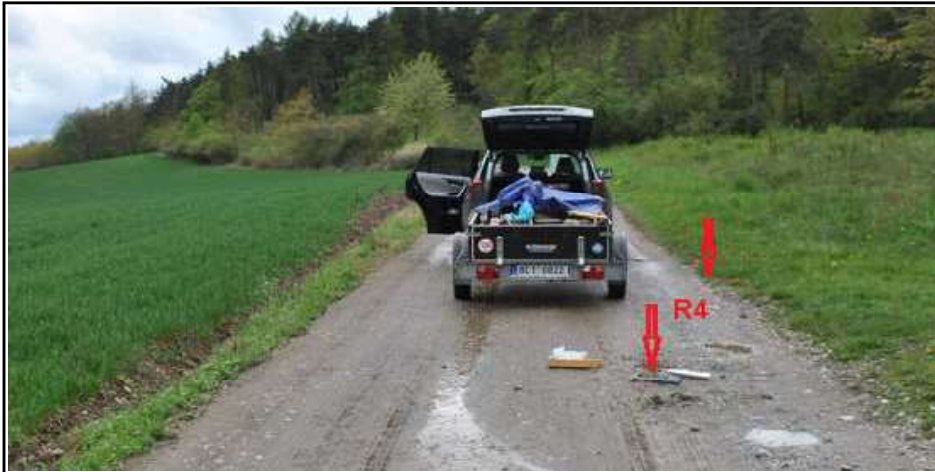
Obr. č. 9 : Pohled na dokumentační bod R4 – výchoz zdravé zelené břidlice , pevné, v úseku staničení km 0,95 (13 m před vytýčeným bodem projektované sondy S4 - šipka) . Měření tvrdoměrem prokázalo pevnost v prostém tlaku \sigma_c \sim 45 \text{ MPa} , s kritériem třídy R3-R2 (6. třídy těžitelnosti).
