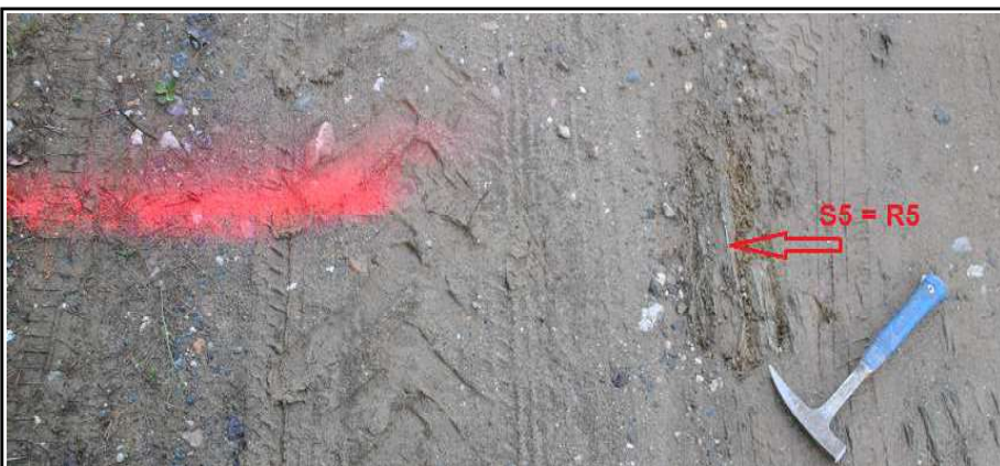
Obr. č. 12 : Přiblížený pohled na dokumentační bod R5 v označeném místě projektované sondy S5 , v úseku staničení km 1,26 . Měření tvrdoměrem prokázalo pevnost v prostém tlaku \sigma_c \sim 25 \text{ MPa} , s kritériem třídy R3, středně pevné.
