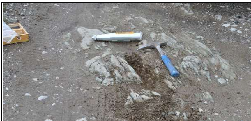
Obr.č. 6: Pohled na geologický profil sondy S3, hluboké 0,7 m. Pod konstrukcí stávající cesty tl. 350 mm složené z písčitého štěrku a lomové štěrkodrtě zastížena navětralá zelená břidlice, málo pevná, silně rozpukaná, třídy R4. Pozn. V celém profilu sonda dlátována.
