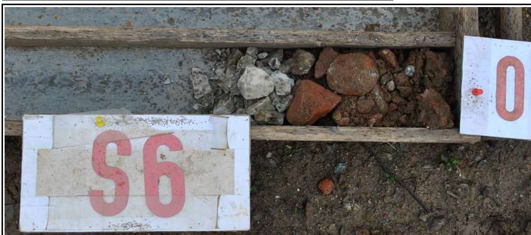
Obr.č. 14 : Přiblížený pohled do vzorkovnice na geologický profil sondy S6, hluboké 0,3m. Pod vrstvou cihelného recyklátu zastižena navětralá, středně pevná zelená břidlice, třídy R3. Sonda provedena dlátováním.
