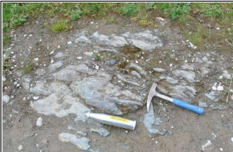
Obr. č. 11 : Přiblížený pohled na dokumentační bod R9 ) . Měření tvrdoměrem prokázalo pevnost v prostém tlaku \sigma_c \sim 32 \text{ MPa} , s kritériem třídy R3, středně pevná.
