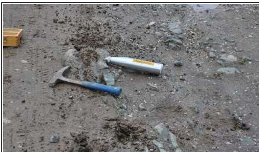
Obr. č. 8 : Pohled na dokumentační bod R8 – výchoz zdravé zelené břidlice , pevné, v úseku staničení km 0,813 . Měření tvrdoměrem prokázalo pevnost v prostém tlaku \sigma_c \sim 50 \text{ MPa} , s kritériem třídy R3-R2 (6. třídy těžitelnosti).
