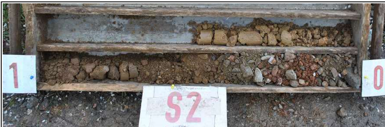
Obr.č. 4: Pohled na geologický profil sondy S2, hluboké 1,5 m. Pod konstrukcí stávající cesty tl. 450 mm složené z lomové štěrkodrtě a písčitého štěrku, zastížena hlína písčitá, pevné – od 1,1 m okrově hnědá hlína prachovitá, velmi pevné konzistence, v profilu obsahující drobné úlomky břidlice do vel. 3 cm. Podzemní voda se v sondě neprojevila.
