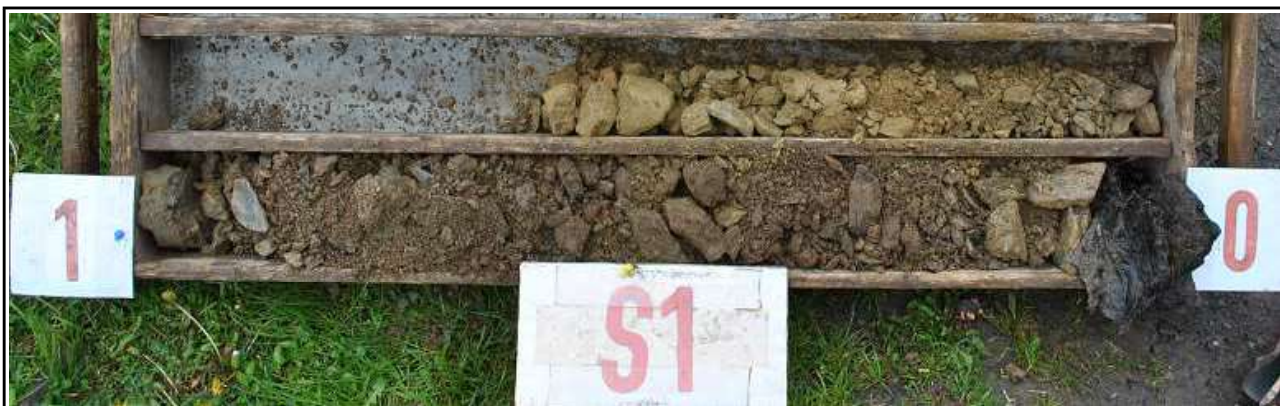
Obr.č. 2: Pohled do vzorkovnice na geologický profil sondy S1, hluboké 1,5 m. Pod konstrukcí stávající cesty tl. 300 mm složené z penetr. makadamu a lomové štěrkodrtě zastížena hlinitá suť, ulehlá, nasedající v hloubce 1 m na zelenavě žluté mírně zvětralé břidlicové podloží, velmi málo pevné, pevnostní třídy R5. Podzemní voda se v sondě neprojevila.
