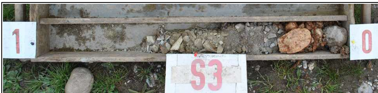
Obr.č. 6: Pohled na geologický profil sondy S3, hluboké 0,7 m. Pod konstrukcí stávající cesty tl. 350 mm složené z písčitého štěrku a lomové štěrkodrtě zastížena navětralá zelená břidlice, málo pevná, silně rozpukaná, třídy R4. Pozn. V celém profilu sonda dlátována.
