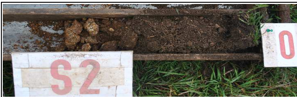
Obr.č. 4 : Pohled na geologický profil sondy S2, hluboké 0,4 m. Svrchní vegetační vrstva s příměsí hrubého písku nasedá v hloubce 0,3 m přímo na mírně zvětralé žulové podloží, málo pevné, pevnostní třídy R4. Níže nehloubitelné ani dlátováním.
