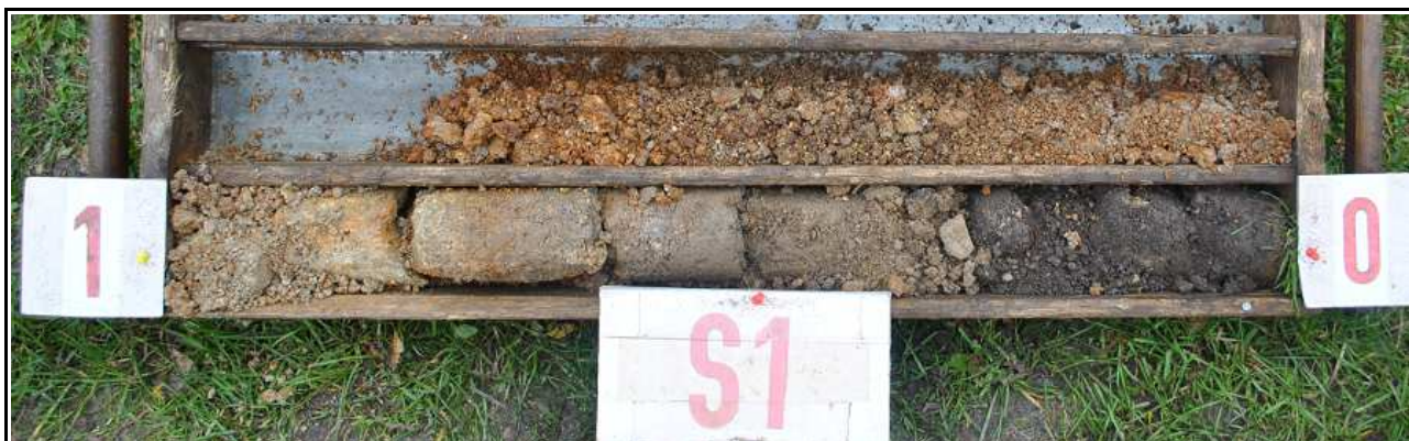
Obr.č. 2 : Pohled do vzorkovnice na geologický profil sondy S1, hluboké 1,8 m. Při povrchu zastižena písčité hlína, drnová , nasedající na šedý jílovito-štěrkovitý písek, soudržný, ulehlý, s hojnou ostrohr. drtí a úlomky do vel. 3 cm. V hloubce 0,7 m zastižena zcela zvětralá žula pevnostní třídy R6, povahy ulehlé, bělošedé-rezavě smouhaté hrubě písčité zeminy. Hloubení ukončeno v silně zvětralé žule třídy R5. Podzemní voda se v sondě neprojevila.
