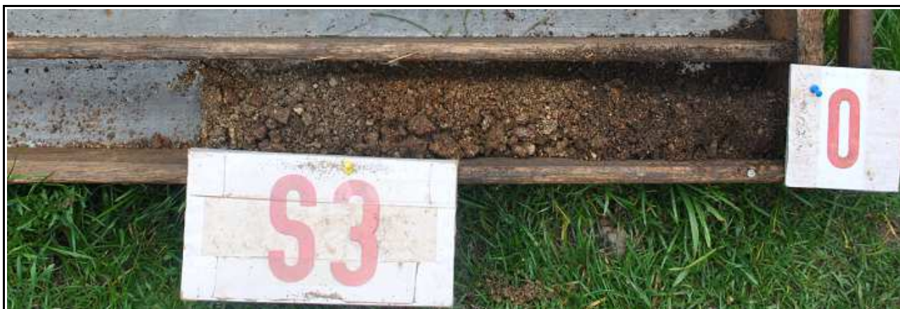
Obr.č. 64 : Pohled na geologický profil sondy S3, hluboké 0,6 m. Svrchní vegetační vrstva s příměsí hrubého písku nasedá v hloubce 0,2 m přímo na zcela zvětralé žulové podloží, pevnostní třídy R5 , od 0,4 m s přechodem do silně zvětralé žuly, více zpevněné, třídy R5-R4 . Hloubení ukončeno v mírně zvětralé málo pevné skalní hornině třídy R4.
