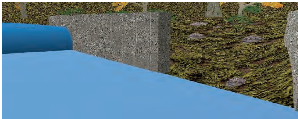
20. Rozdělení kolmé stěny podél toku s příčnou překážkou může zlepšit bezpečnost vyder na místech popsaných na obr. 17A. Průchod zvířeti umožní vrátit se do toku poté, co obešlo příčnou překážku (např. jez).
