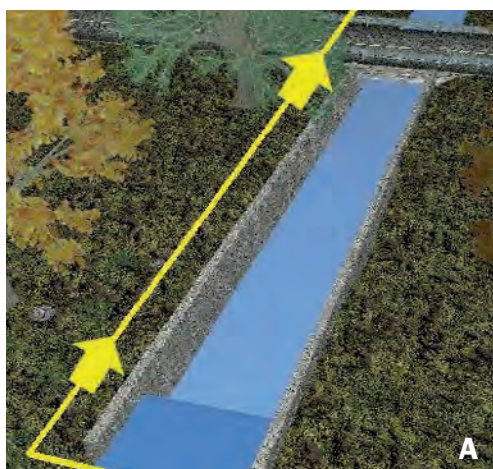
17. Vysoký jez , za kterým se podél toku táhnou z obou stran svislé stěny až po křížení toku s komunikací, představuje pro vydra velmi rizikovou situaci. Zvíře jez obejde mimo tok, ale pak se již nemá možnost do něj vrátit a křížící silnici tedy nemůže podejít, ale musí ji přebíhat vrchem (A). Řešením takové situace je např. přerušení svislé zdi co nejbližší za jezem (B, detail viz obr. 20), aby zvíře mělo možnost se po jeho obejítí hned vrátit do toku. Šipky naznačují pohyb vydry v dané situaci.
