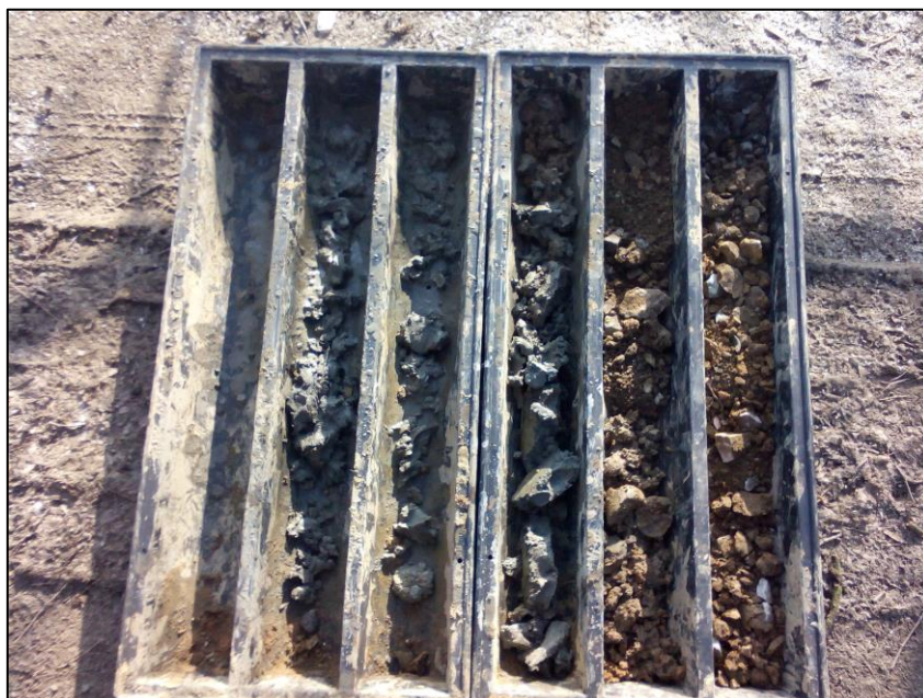
FOTO č.1: geologický profil vrtu J1 (metr 5-6 byl odebrán kvůli vlhkosti ihned do igelitového sáčku)
