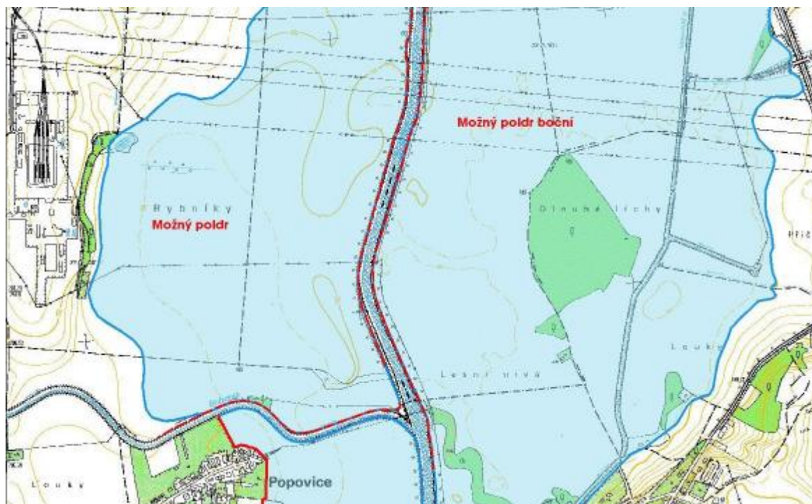
Obr. 11: Možnosti retence povodňových průtoků nad zájmovým územím [12]
