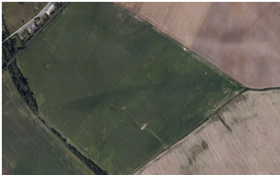
Obrázek 86: Příklad dopadu vodní eroze. V rámci údolnice je patrná dráha soustředěného odtoku. Severozápadní část EHP – DO19 (satelitní snímek z roku 2018, Mapová data Google).
