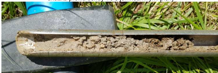
ukázka profilu sondy V3 s jemnozrnnými písky
