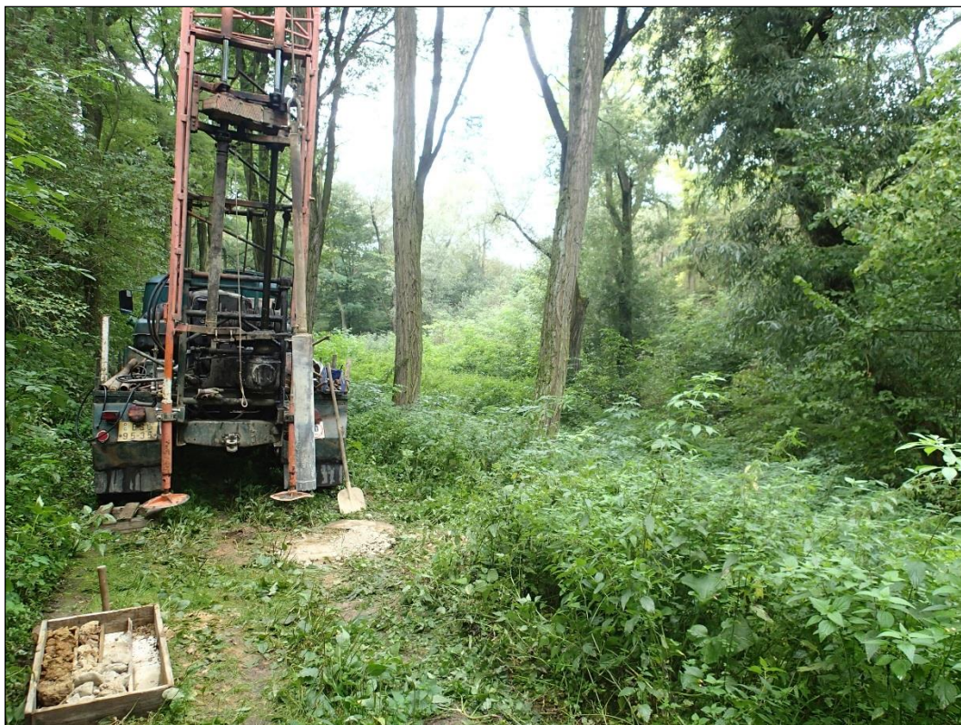
Obr. 3 - Fotodokumentace provedeného inženýrskogeologického průzkumu (V1)
