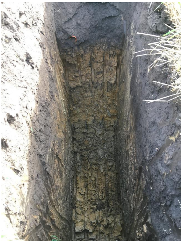
Kopaná sonda v zemníku
